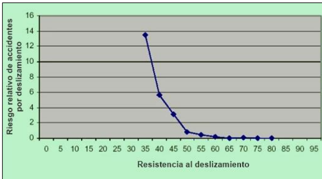
Figura 2-10. Riesgo relativo de accidentabilidad por efecto de la variación de la resistencia al deslizamiento. Fuente: (Leiva, 2005)
