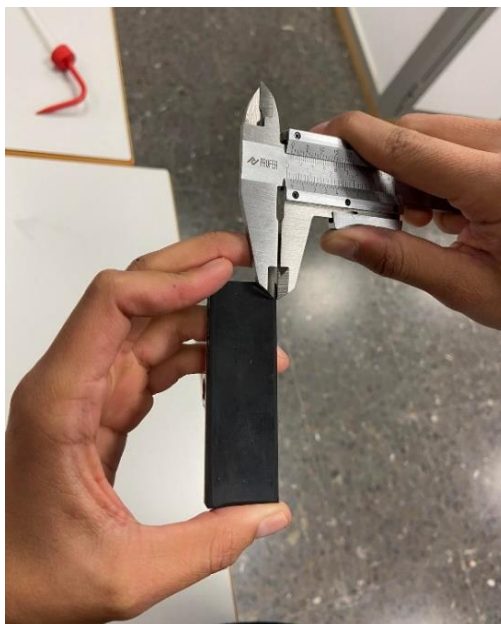
Figura 5-9. Medición del desgaste en el caucho del patín. Fuente: Propia
