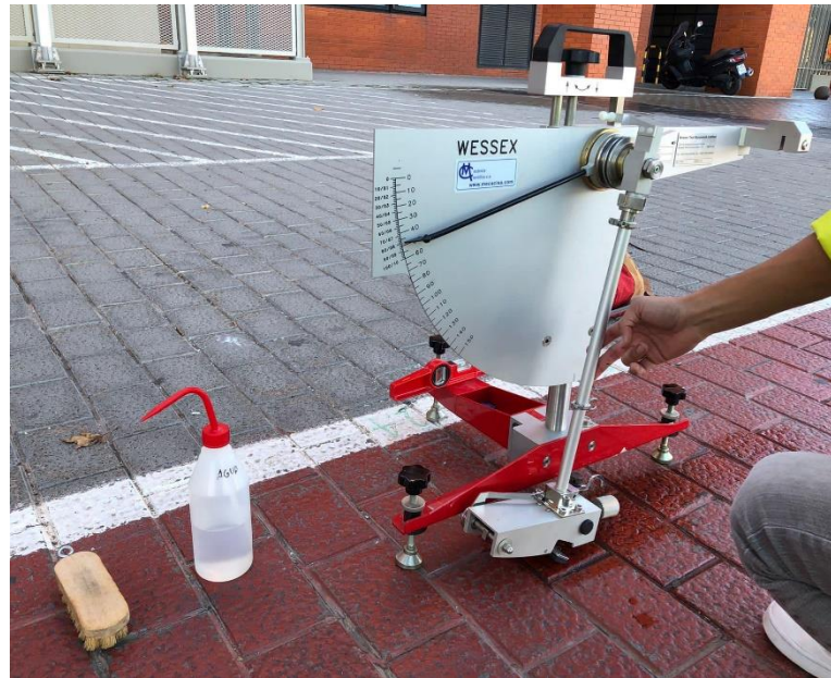
Figura 5-8. Toma de medidas con el péndulo de fricción. Fuente: Elaboración propia
