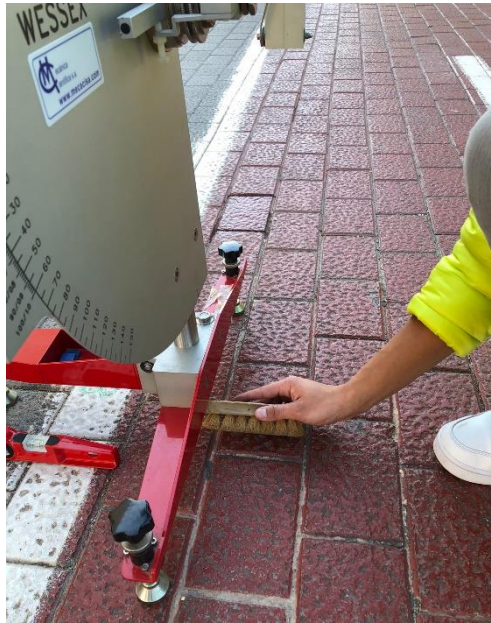
Figura 5-4. Proceso de limpieza del área de ensayo. Fuente: Propia
