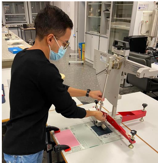
Figura 5-3. Acondicionamiento del patín nuevo a emplearse en el ensayo. Fuente: Propia
