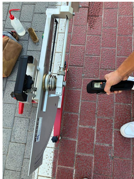
Figura 5-7. Medición de la temperatura en el área de ensayo. Fuente: Propia
