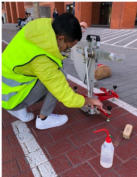
Figura 5-5. Comprobación del cero en la aguja indicadora. Fuente: Propia
