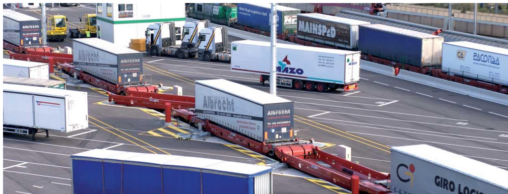
Ilustración 39 - Sistema Modalohr. Fuente: https://lohr.fr/es/lohr-railway-system/las-terminales-del-sistema-lohr/
