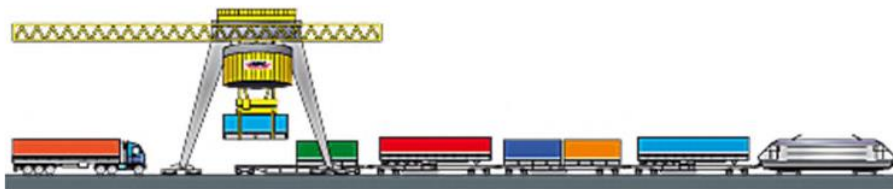
Ilustración 42 - Sistema de vagones "poche". Fuente: Estudio para el desarrollo de Autopistas Ferroviarias en la Península Ibérica
