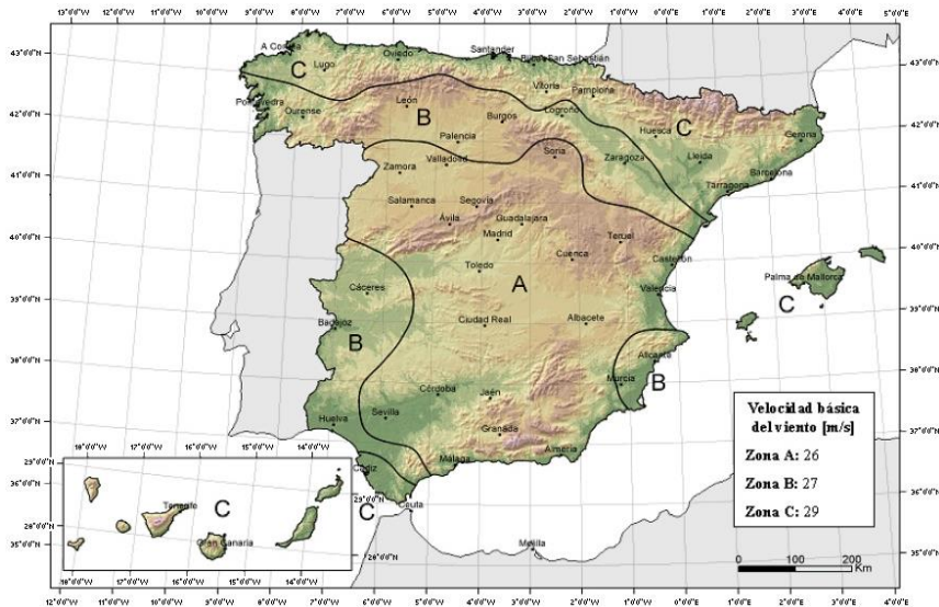
Figura 2. Mapa eólico de España según el valor básico de la velocidad del viento. Fuente: DBSE-AE del CTE
