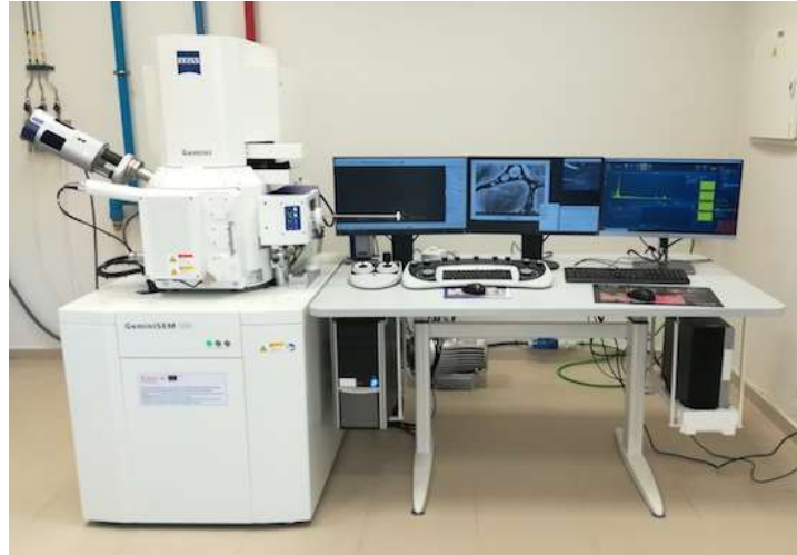
Figura 13. Microscopio electrónico de barrido de emisión de campo (Universidad Politécnica de Valencia). Modelo Gemini SEM500 (Zeiss).
