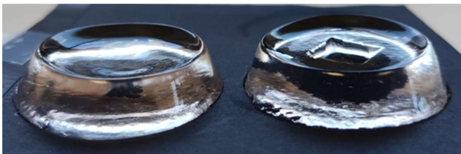
Figura 11. Izquierda: hidrogel sintetizado en bulk (tras 48 horas sumergido en PBS-T) de apariencia transparente y uniforme en todos sus puntos y una morfología circular. Derecha: grating de hidrogel fabricado por réplica de molde holográfico (tras 48 horas sumergido en PBS-T).
