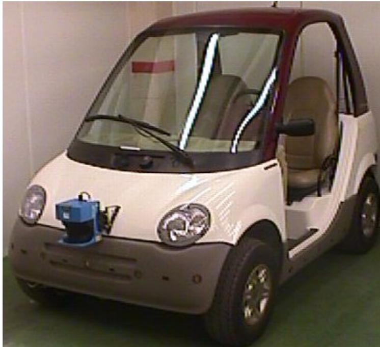
Figura 9.31- Vehículo eléctrico de pruebas sobre el que implementar el planificador de aparcamiento desarrollado
