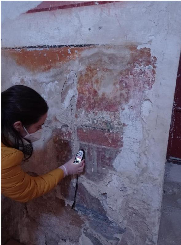
**Figura 38.** Medición cromática con colorímetro modelo RM200QC de X-Rite.
