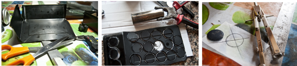
Ilustración 55: Realizando estenopos de 0,25 mm a partir de un bote de helado vacío.
