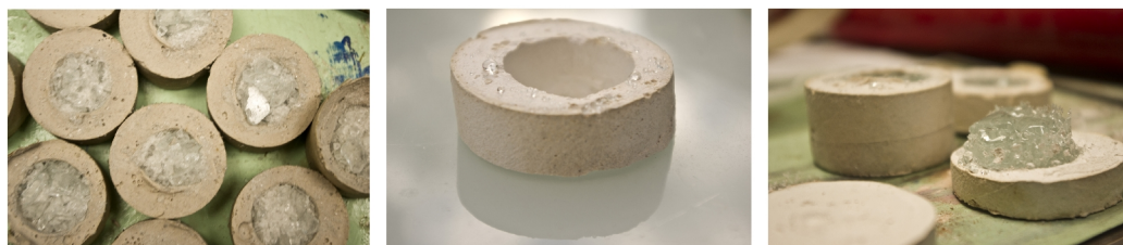
Ilustración 53: Moldes de escayola y chamota con cristal para fundir, antes y después del horneado. Como se puede ver en la última diapositiva, esta prueba falló porque no se alcanzó la temperatura y el tiempo necesarios para derretir completamente el cristal.
