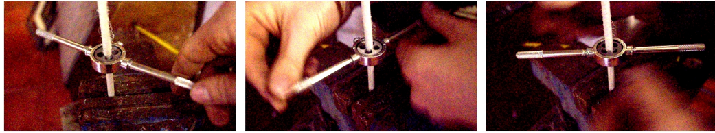
Ilustración 35: Roscando una pieza de prueba para la cámara, que finalmente se descartó.
