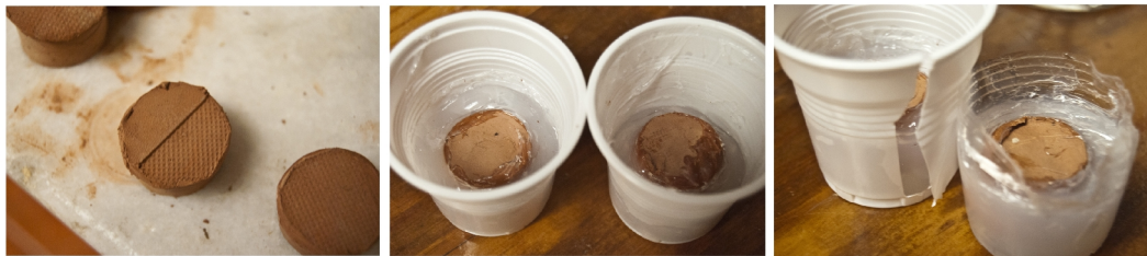
Ilustración 52: A la izquierda, el positivo en arcilla sacado de la parte macho del tapón roscado y utilizado para fabricar el molde de silicona para los objetivos de hielo.
