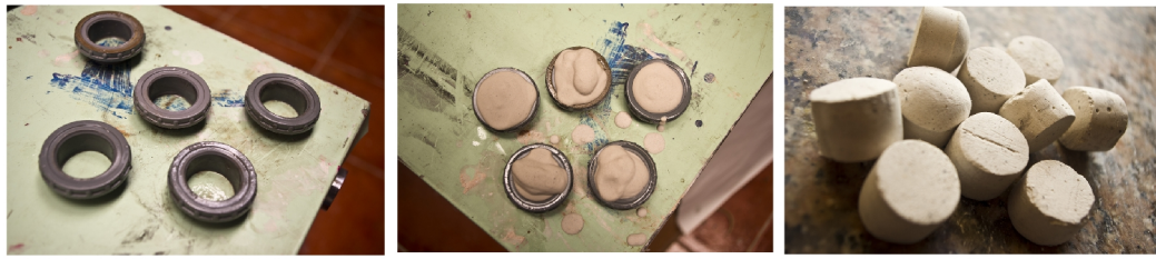
Ilustración 54: Aquí podemos ver otra manera de extraer los positivos en escayola a raíz del tapón de registro macho, a los que se aplica desmoldante. Éste procedimiento se descartó debido al trabajo y dificultad que suponía para obtener buenos resultados.
