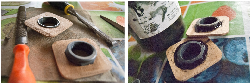
Ilustración 44: Pegado de las piezas con resina epoxi y pigmento negro.
