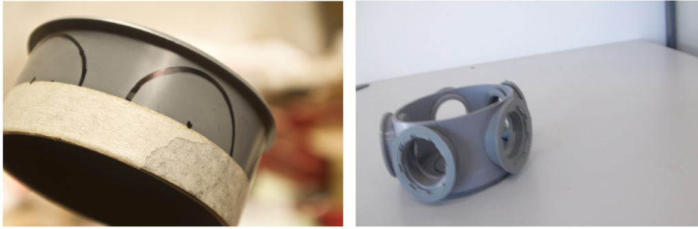
Ilustración 31: A la izquierda las marcas para realizar las perforaciones, a la derecha la cámara con las monturas encoladas con pegamento especial para PVC.
