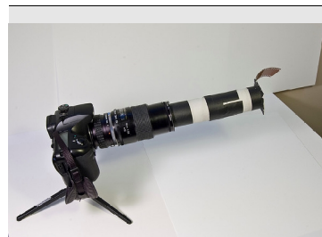
Ilustración 62: dispositivo casero para digitalizar negativos y diapositivas.
