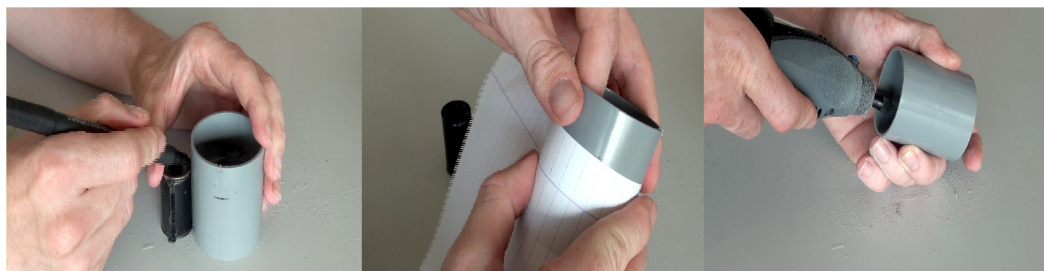
Ilustración 24: Construcción del plano focal a raíz de las medidas de un chasis desmontable.
