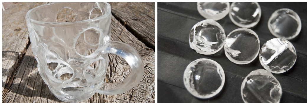
Ilustración 50: Lentes simples extraídas de una jarra de cerveza.
