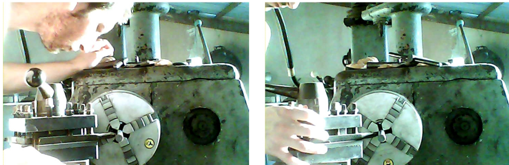
Ilustración 38: Construcción de los rodamientos a partir de un sólido cilíndrico de pvc.
