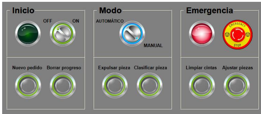
Ilustración 39. HMI con emergencia activa.
