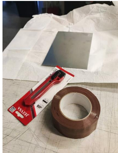
Fig. 62, Materiales para cubrir la parte trasera de la plancha y protegerla del ácido para no ser intervenida , Álvaro Ulloa, UPV, Valencia, 2022.
