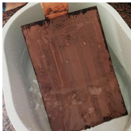
Fig. 74, Planchas siendo mordidas en el ácido, Álvaro Ulloa, UPV, Valencia, 2022.
