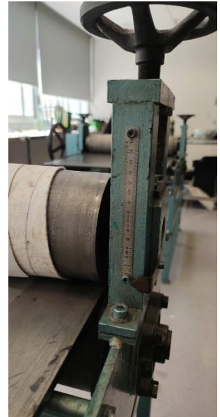
Fig. 108, Presión tórculo parte derecha, Álvaro Ulloa, UPV, Valencia, 2022.
