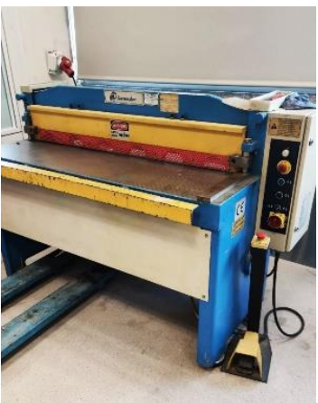
Fig. 58, Guillotina Eléctrica para cortar cada una de las planchas en 4 partes iguales obteniendo así 8 planchas para trabajar , Álvaro Ulloa, UPV, Valencia, 2022.
