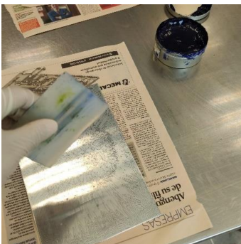
Fig. 101, Entintado de la matriz 1ra Parte, Álvaro Ulloa, UPV, Valencia, 2022.
