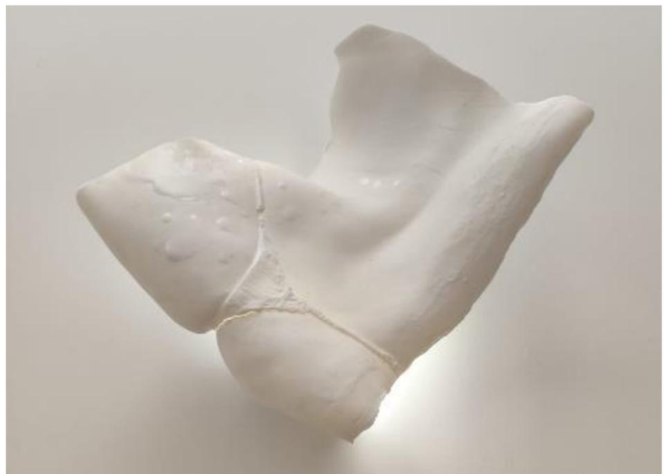
**Figura 35.** Pieza después de la cocción a 1250°C
