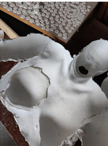
**Figura 33.** Placa de porcelana dentro del molde de escayola
