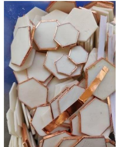
**Figura 47.** Piezas forradas con cinta de cobre
