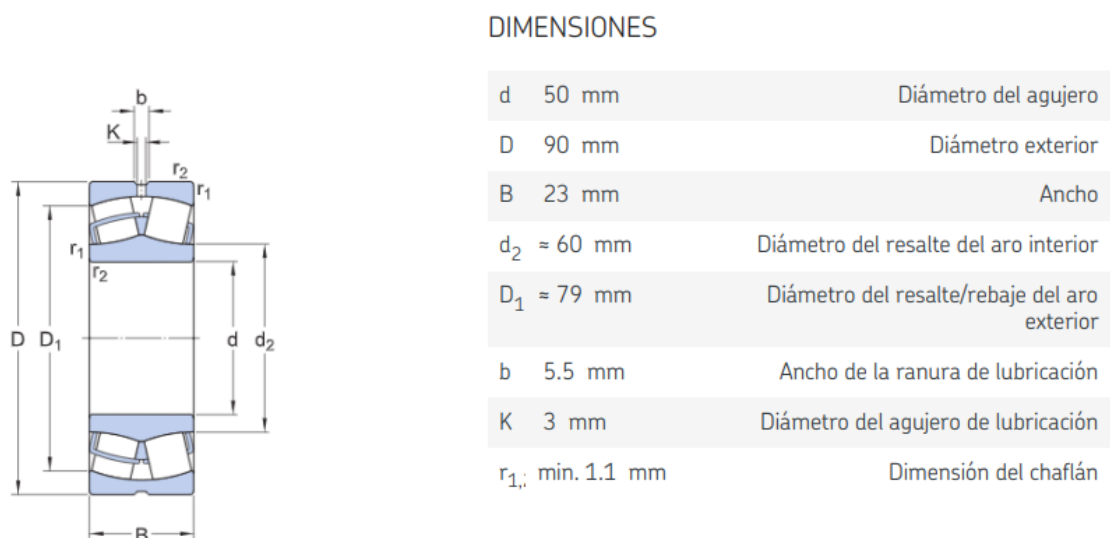
Figura 9.26: Dimensiones del rodamiento 22210 E [46].
