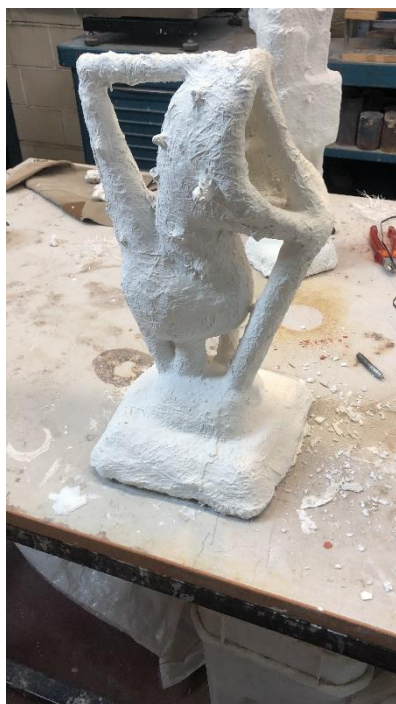
Fig. 49 Cabeza de cigüeña con cascarilla cerámica.
