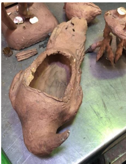
Fig. 63 Cuervo arenado después de cortar bebederos en ambas partes.
