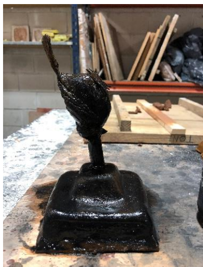
Fig. 40 Gorrión cubierto con gomalaca con copa y bebedero.
