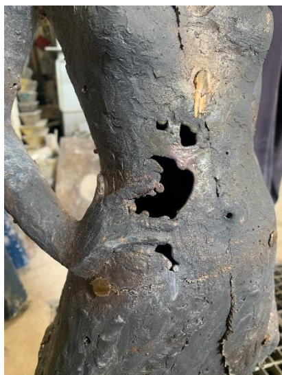
Fig. 30 Figura con un grosor inferior al recomendado, resultado tras la colada.
