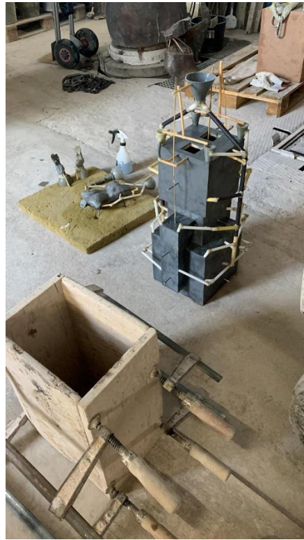
Fig. 46 Cajas de madera y las figuras que van a ser introducidas en los moldes de chamota.
