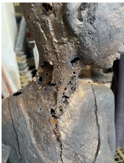
Fig. 38 Detalle de cocción de metal en una escultura.
