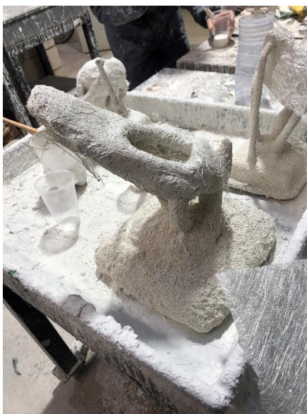
Fig. 48 Cuervo cubierto en cascarilla cerámica.
