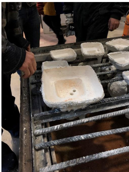
Fig. 52 Moldes de cascarilla cerámica colocados en el lecho de colada.
