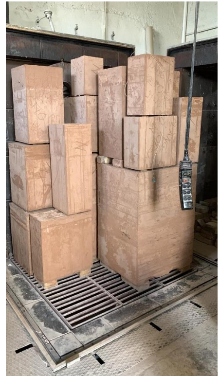
Fig. 47 Moldes de chamota colocados en el horno de secado.
