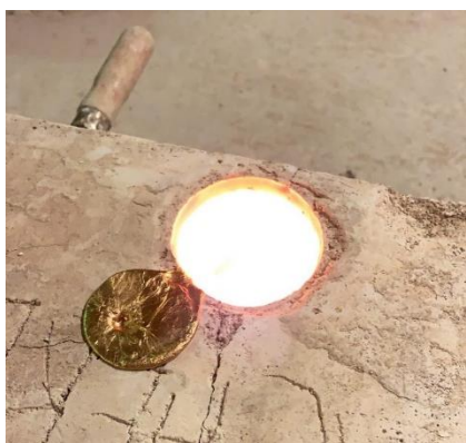
Fig. 56 Molde de chamota con metal.
