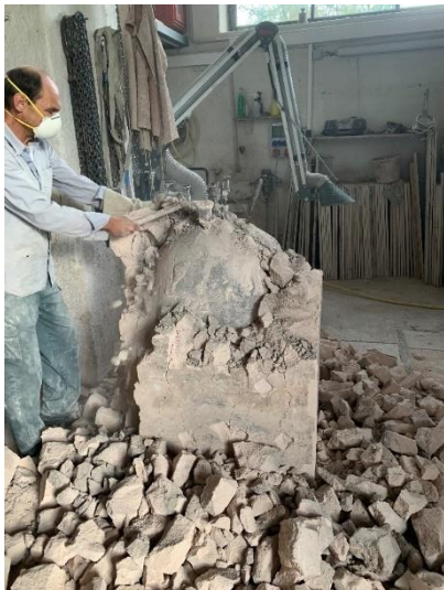
Fig. 60 Acción de retirada del molde de chamota de la pieza de bronce.
