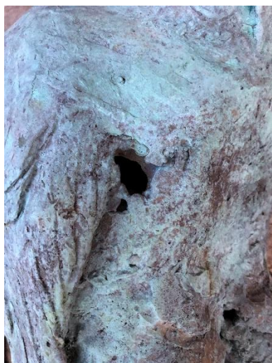
Fig. 72 Alteración del metal en la cigüeña.
