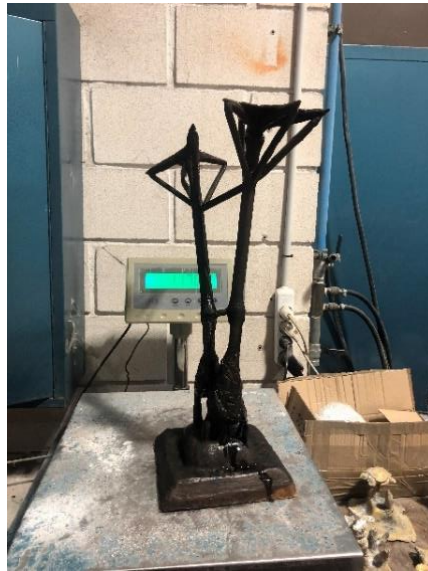
Fig. 43 Patas cigüeña con bebederos, copa y gomalaca.
