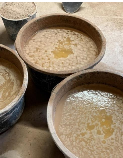
Fig. 45 Mezcla de chamota preparada para entrar en las cajas de madera
