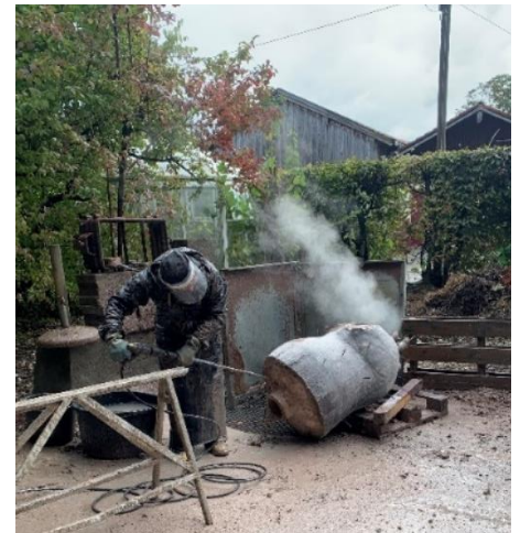
Fig. 58 Acción vaciado del núcleo mediante empleo de pistola de agua a presión.
