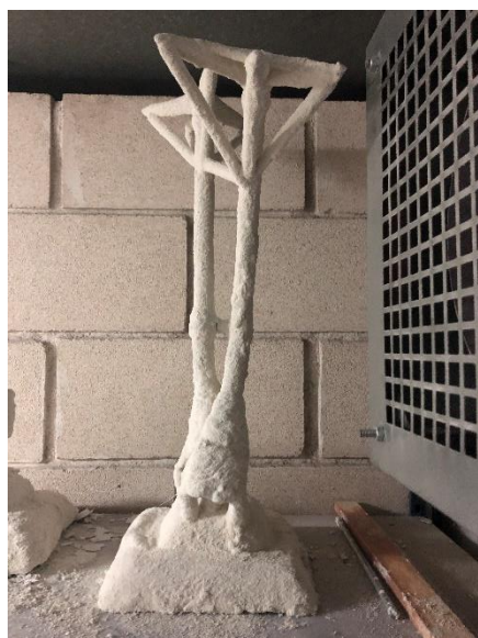
Fig. 50 Patas cigüeña con cascarilla cerámica en armario de secado.
