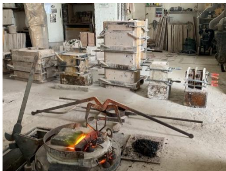
Fig. 54 Horno de fundición y moldes de chamota preparados para la colada.
