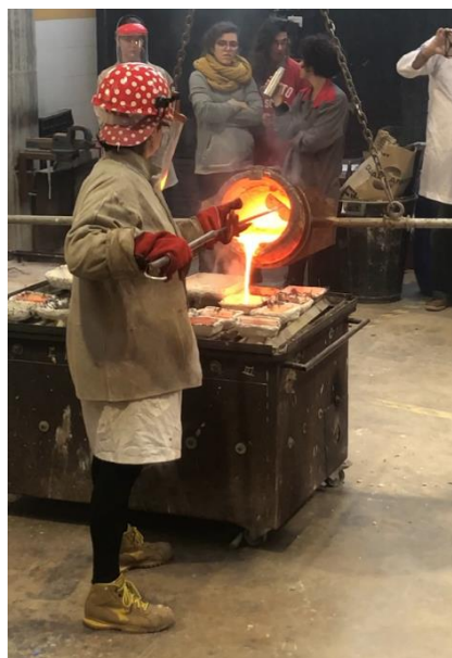
Fig. 55 Acción de colada en la Universidad Politécnica de Valencia.
