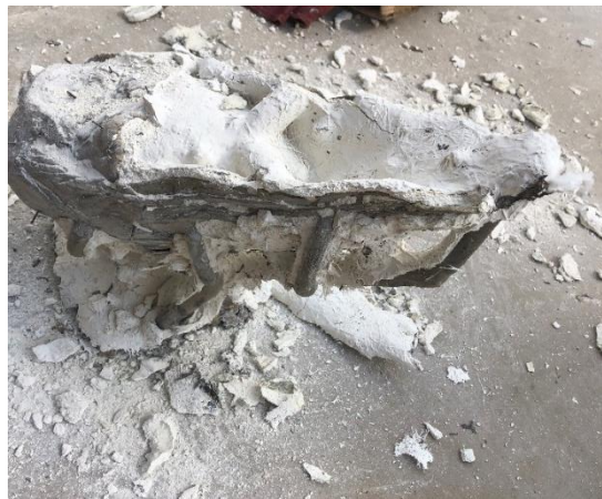
Fig. 59 Cuerpo cigüeña con cascarilla cerámica en el proceso de descascarillado.
