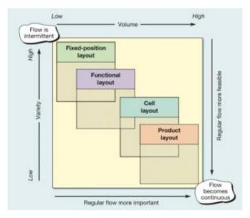
Figure 5.Choice of plant layout type (Fuente: <u>http://evaluador.doe.upv.es</u>)
