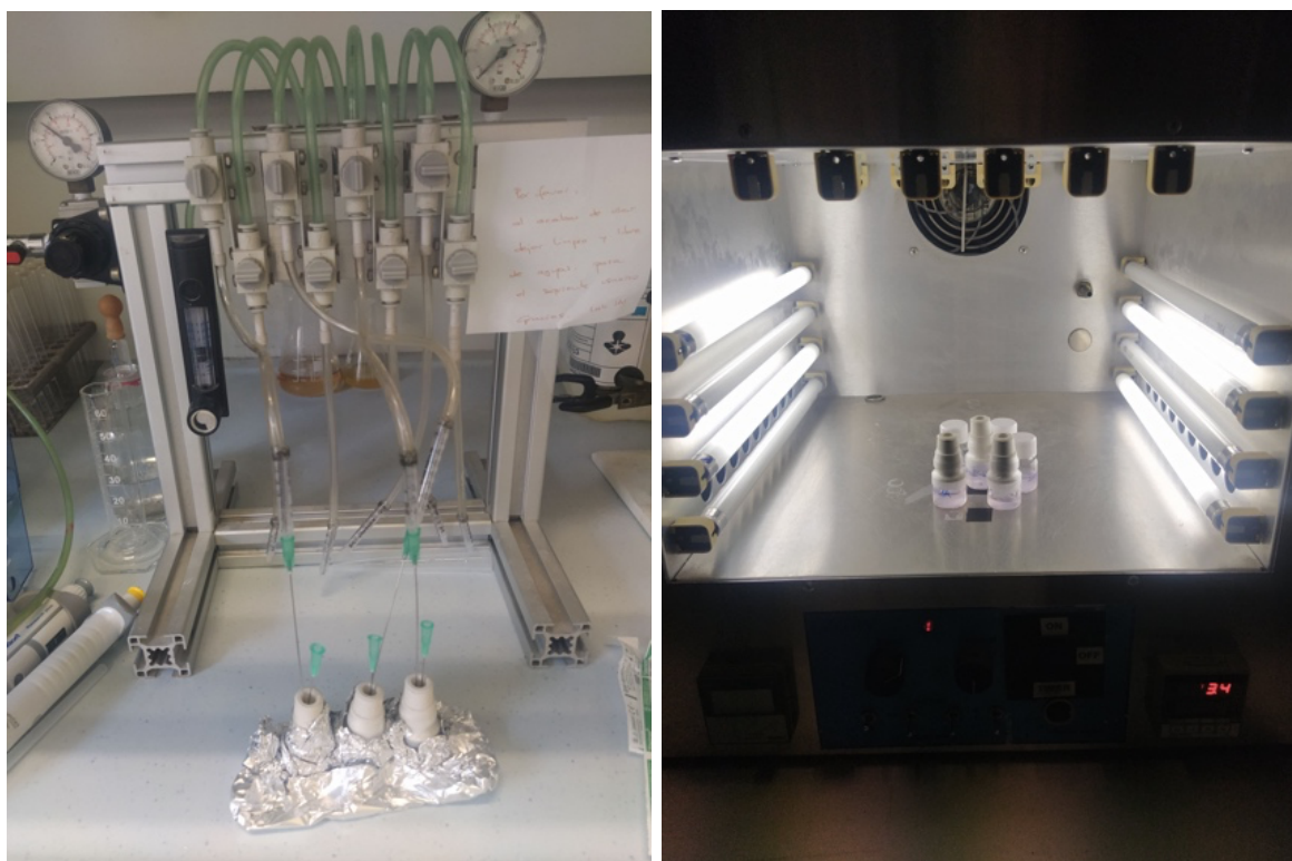
Figura 20. A la izquierda, sistema de purgado de los viales, mediante el cual se desplaza el oxígeno de los viales que se irradiarán en anaerobiosis. A la derecha, imagen del fotorreactor Luzchem LZC 4V encendido con los 6 viales de muestra dentro
