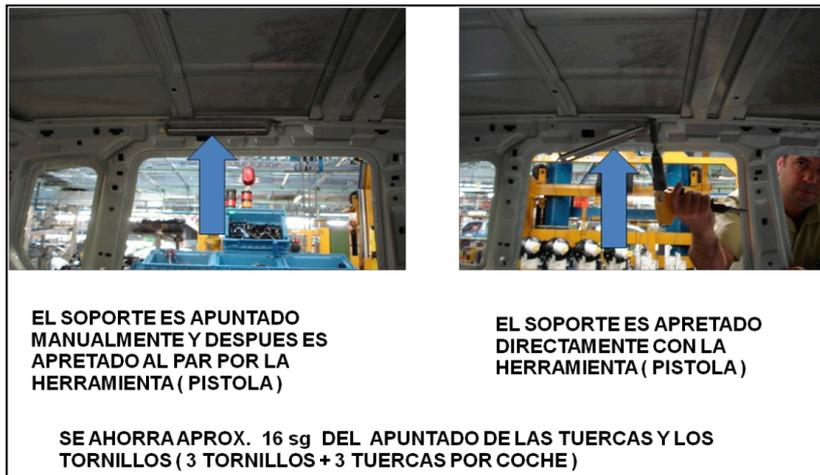
Figura 4.8-2. Ejemplo típico de mejora del montaje de elementos sencillos eliminado elementos que no aportan valor añadido
