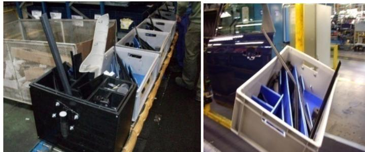
Figura 4.8-1 . Propuesta de caja kitting vertical para la línea de puertas adaptada para piezas de gran longitud
