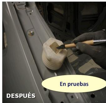
Figura 4.8-5. Accesorio diseñado para la limpieza de espátulas
