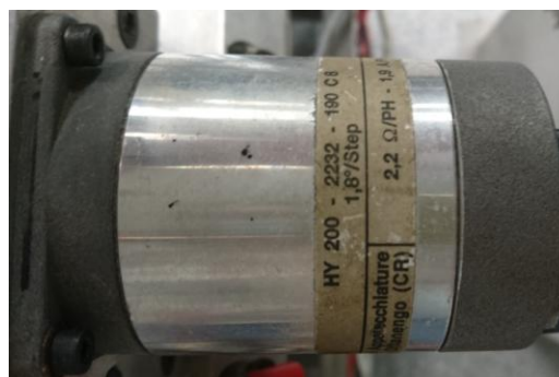
Figura 34. Tipo de motor PAP empleado para el movimiento de los ejes.
