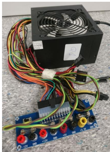
Figura 40. Fuente de alimentación disponible para la alimentación de la cama calefactable.
