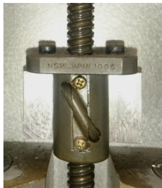
Figura 31. Husillo correspondiente al eje Z.
