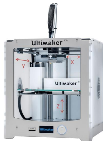
Figura 3. Ejemplo de una impresora 3D cartesiana con cinemática XY.
