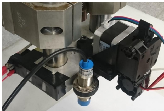
Figura 73. Todos los componentes (conjunto extrusor, sensor y respectivos soportes) ensamblados en el carro.
