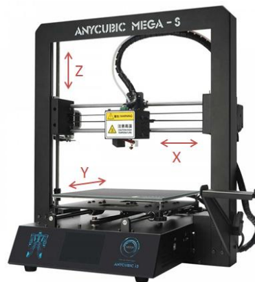
Figura 2. Ejemplo de una impresora 3D cartesiana con cinemática XZ.
