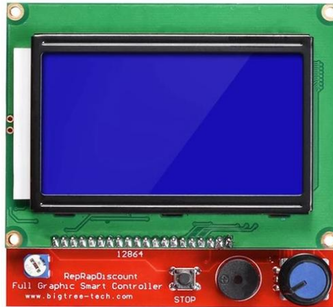
Figura 54. Ejemplo de LCD empleado en Impresoras 3D.
