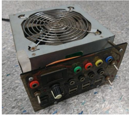
Figura 39. Fuente de alimentación empleada para el funcionamiento de la placa STEVAL-3DP001V1.
