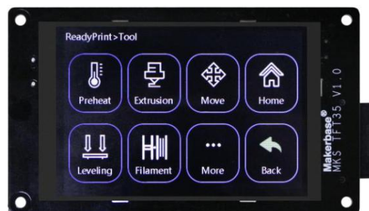
Figura 23. Ejemplo de un panel táctil empleado en impresoras 3D FDM.
