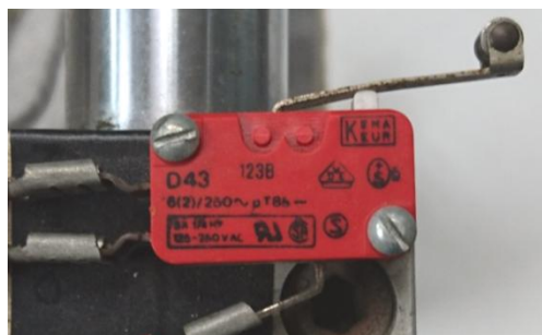
Figura 37. Final de carrera utilizado en la máquina CNC.
