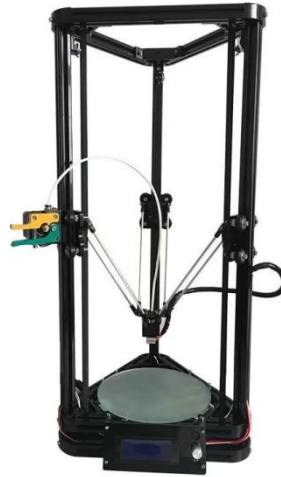
Figura 6. Ejemplo de una impresora 3D con cinemática Delta.
