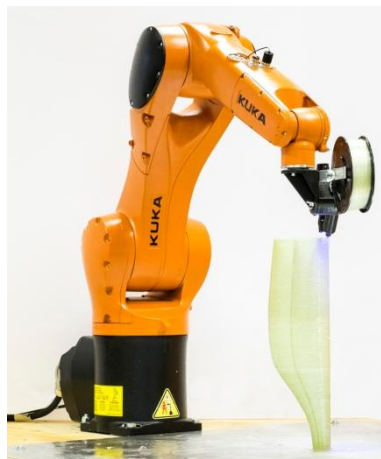
Figura 8. Ejemplo de un robot antropomórfico con funcionalidad de FDM.
