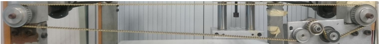
Figura 33. Poleas y correa de transmisión del eje Y.
