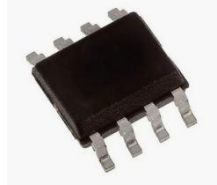
Figura 56. Aislador de canal digital dual STISO621 con direccionalidad 1-1.
