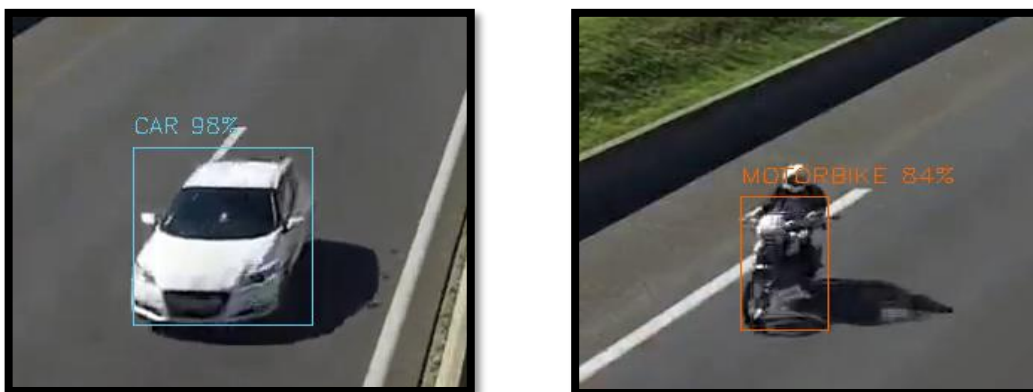
Figura 63 y 64: Detección y clasificación con YOLO
