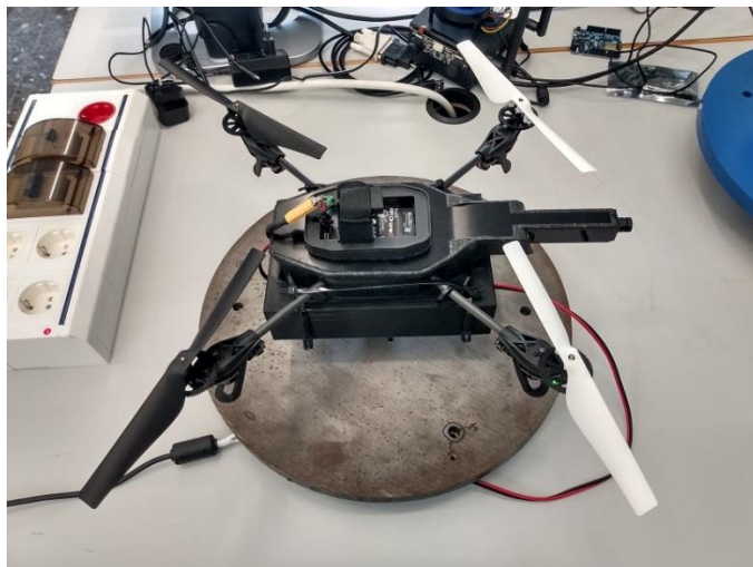
Figura 13. Disposición del dron sobre la base articulada
