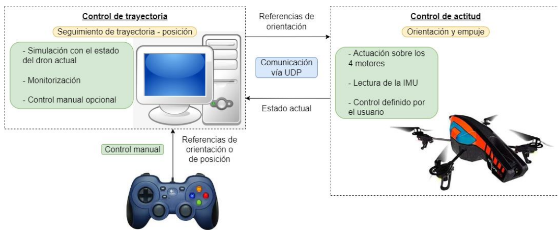
Figura 3. Estructura de la plataforma del trabajo
