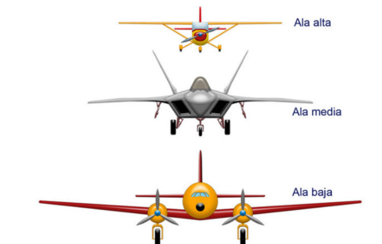
Figura 3.4: Posición de las alas. (Fuente: [5])
