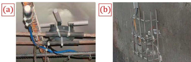
Figura 1. 85- Sensores galvánicos comerciales: (a) Corrowatch® de Force Technology ®369,403,404 y (b) CorroRisk de PCTE 405 . Elaboración propia.
