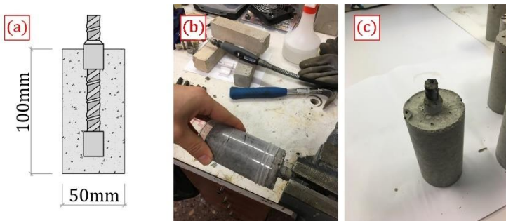
Figura 2. 16- Probetas utilizadas para el ensayo [a]; [b] desmoldado; y [c] resultado final. Elaboración propia.
