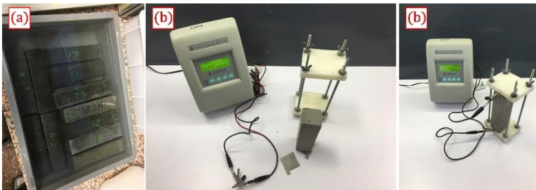
Figura 2.14- Análisis de la resistencia eléctrica del hormigón: (a) inmersión de las probetas durante el periodo de seguimiento; y (b) medida periódica. Elaboración propia.
