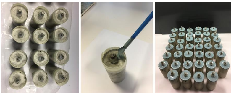
Figura 2.17- Aplicación de pintura en la cara superior de las probetas y protección de la armadura que emerge con vaselina. Elaboración propia.
