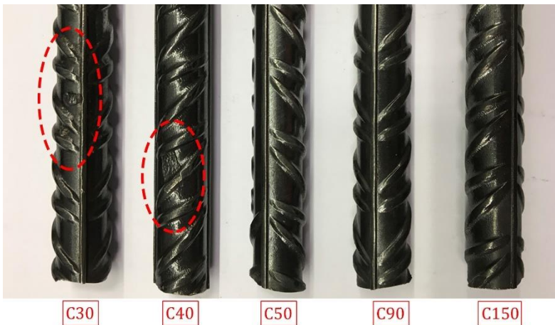
Figura 2. 46- Inspección visual de las armaduras. Detalle de picaduras en las armaduras embebidas en probetas C30 y C40. Elaboración propia.
