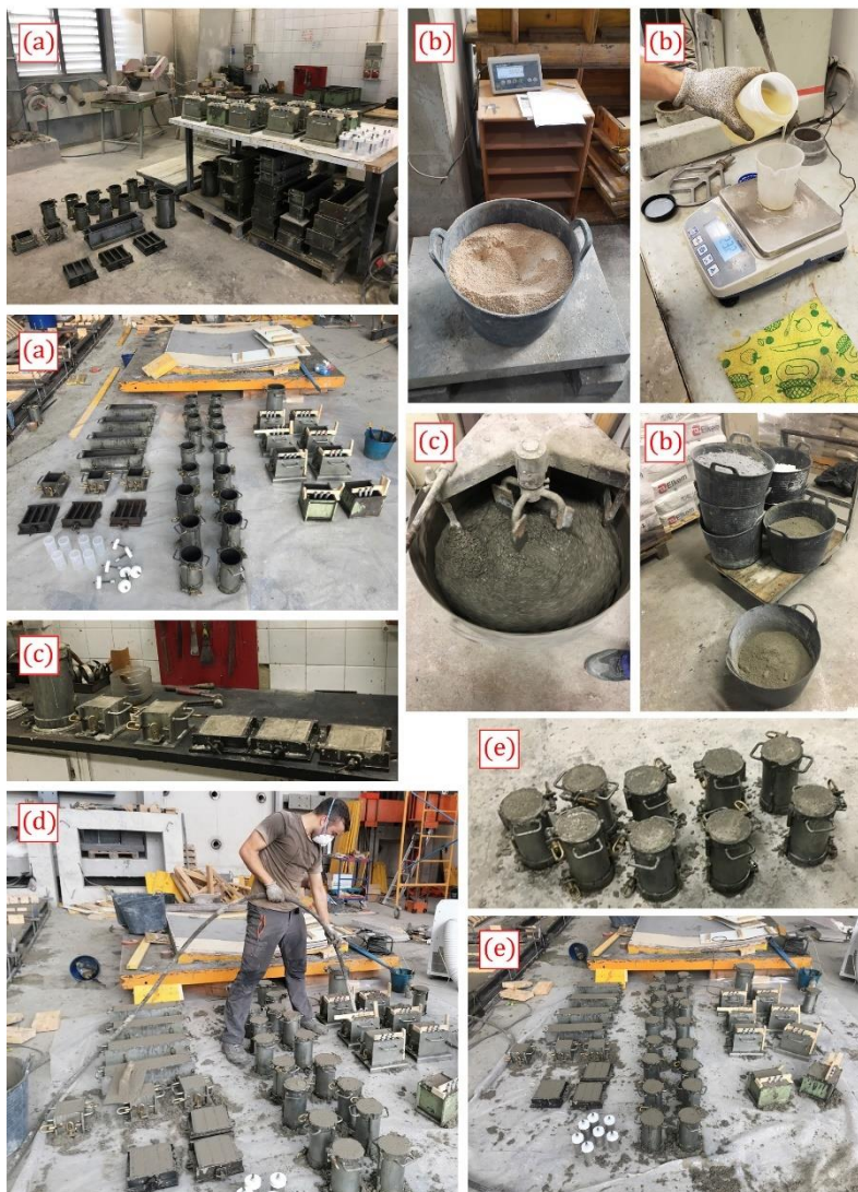
Figura 2. 2- Proceso de hormigonado: (a) preparación de los moldes; (b) preparación y acopio de los materiales; (c) hormigonado; (d) vibrado; y (e) resultado final. Elaboración propia.
