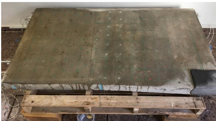
Figura 5. 34- Humectación de la losa para monitorización. Etapa 1. Elaboración propia.
