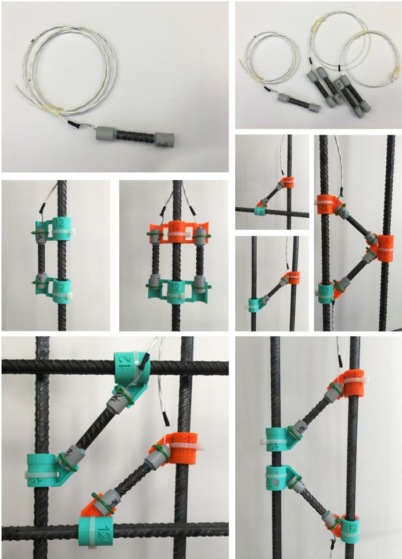
Figura 5.3- Sensores. Soportes con distintas configuraciones para la colocación de los sensores embebidos. Elaboración propia.
