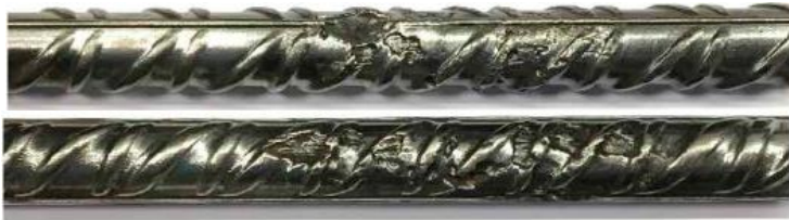
Figura 1. 17- Detalle de varias armaduras con daños por picaduras. Elaboración propia.
