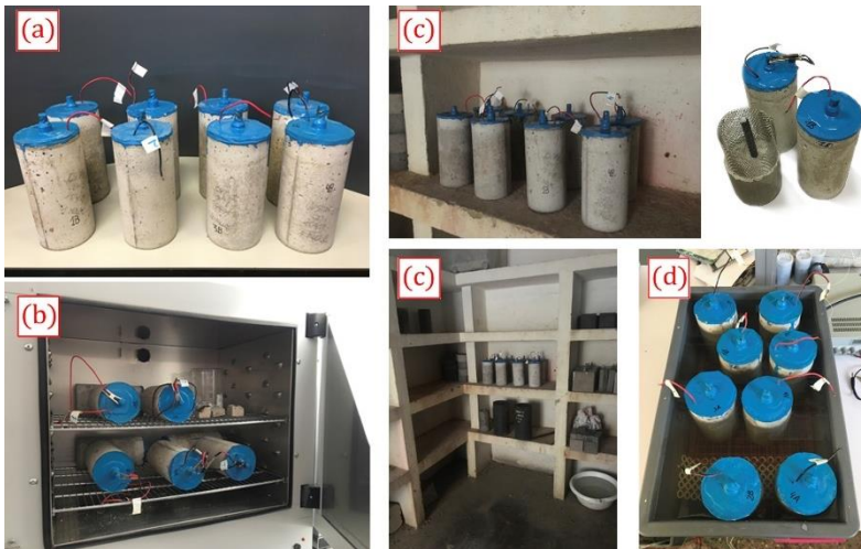
Figura 4. 50- Imágenes de los ciclos de exposición realizados: [a] condiciones de laboratorio; [b] secado en estufa a 40^\circ\text{C} ; [c] cámara con humedad por encima del 95%; y [d] inmersión en disolución. Elaboración propia.
