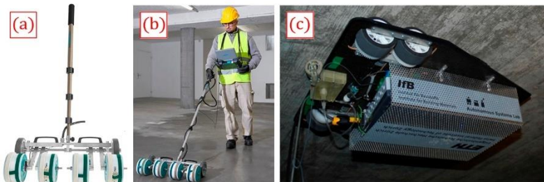
Figura 1. 37- Ejemplos de sistemas para la medida del potencial de corrosión de grandes superficies: (a y b) sistema Canin Corrosion 208 y (c) el equipo Climbing Robot desarrollado por IfB 209 .
