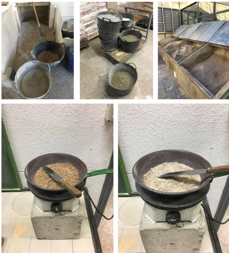
Figura 2. 1- Acopio de los diferentes tipos de áridos utilizados y ejemplo de análisis del contenido de humedad de arena 0/4. Elaboración propia.
