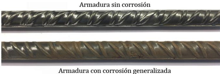
Figura 1. 14- Armadura afectada por una corrosión generalizada. Elaboración propia.
