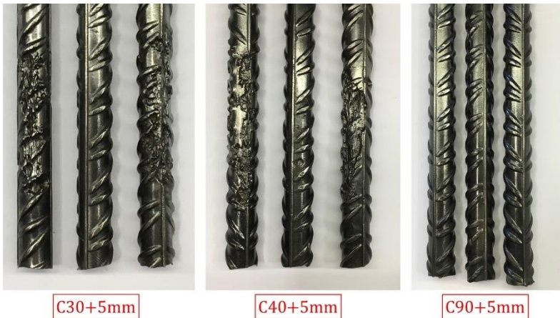
Figura 4. 77- Evidencias del daño producido sobre diferentes armaduras analizadas. Elaboración propia.
