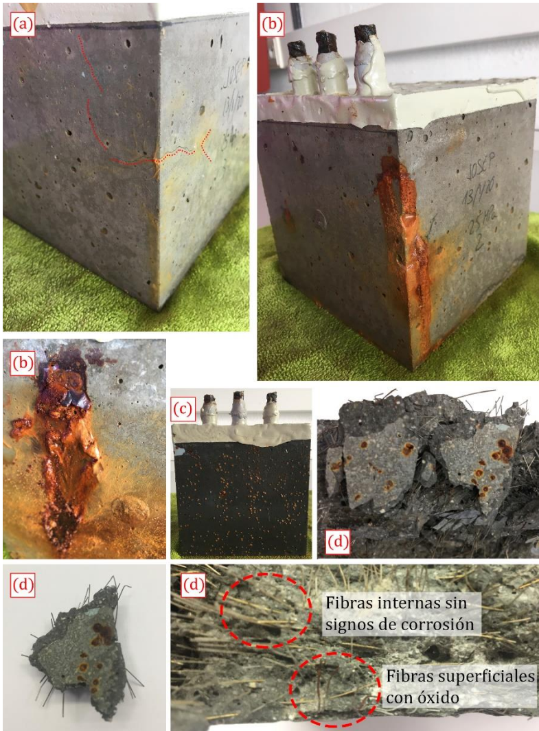
Figura 4.75- Detalle de algunas muestras analizadas: (a) detección de fisuras puntuales en algunos casos, (b) manchas de óxido en esquina y detalle, (c) manchas de óxido por corrosión en las fibras más superficiales en el hormigón C150 y (d) detalle de la corrosión en fibras superficiales del C150. Elaboración propia.
