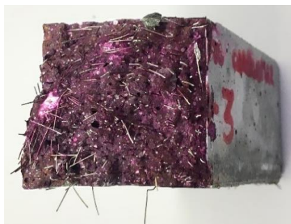
Figura 2. 37- Detalle del revelado de una probeta C150 tras más de un año de exposición en cámara de carbonatación acelerada. Elaboración propia.
