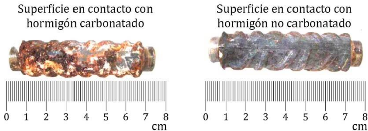
Figura 4. 20- Inspección visual de una armadura afectada por la carbonatación en una de sus caras. 524
