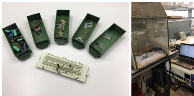
Figura 3. 19- Montaje de circuito mediante elementos resistivos y capacitivos sobre una placa "protoboard". Medición del sistema en jaula de Faraday. Elaboración propia.
