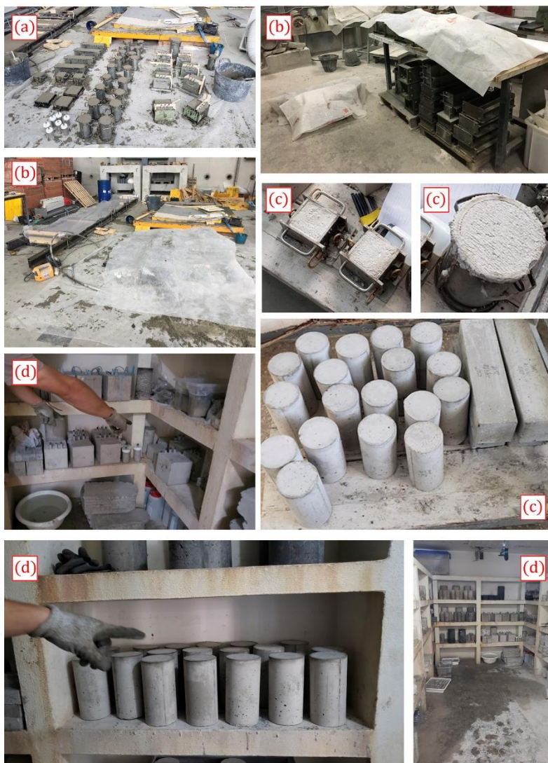
Figura 2. 3- Proceso de curado: [a] fin del hormigonado; [b] curado 48 horas en laboratorio protegiendo las muestras con telas plásticas; [c] desmoldado; y [d] almacenamiento en cámara de curado hasta la edad de 28 días. Elaboración propia.
