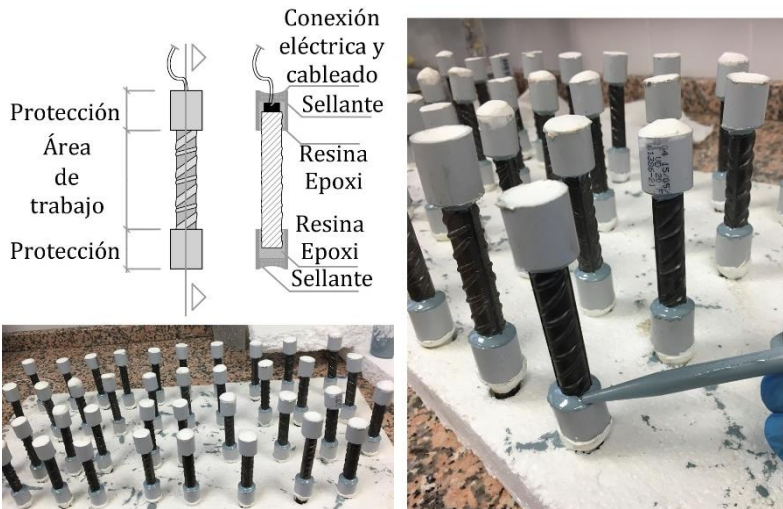
Figura 5.2- Ejemplo de sensor embebido. Proceso de fabricación de los sensores. Elaboración propia.
