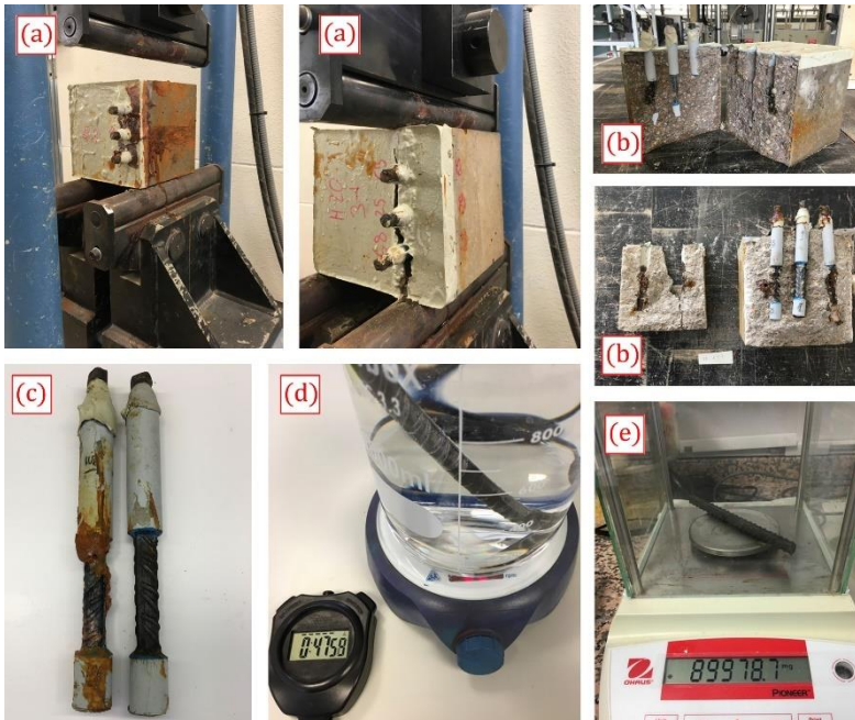
Figura 4. 76- Proceso de (a) rotura de las probetas, (b) inspección visual de las muestras y (c) de las armaduras, (d) ciclos de limpieza y (e) análisis gravimétrico al finalizar la limpieza de las armaduras. Elaboración propia.
