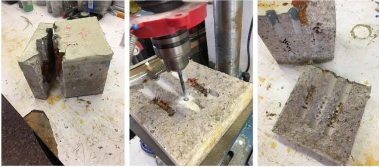
Figura 4. 68- Imágenes de la toma de muestras en las zonas próximas a la armadura. Elaboración propia.
