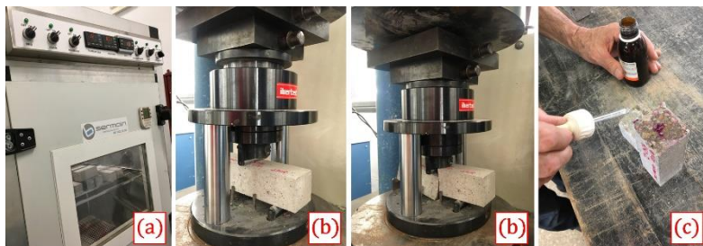
Figura 2. 13- Ensayo de carbonatación acelerada: [a] cámara de exposición; [b] rotura de las probetas mediante ensayo de tracción indirecta; y [c] revelado del frente de carbonatación. Elaboración propia.
