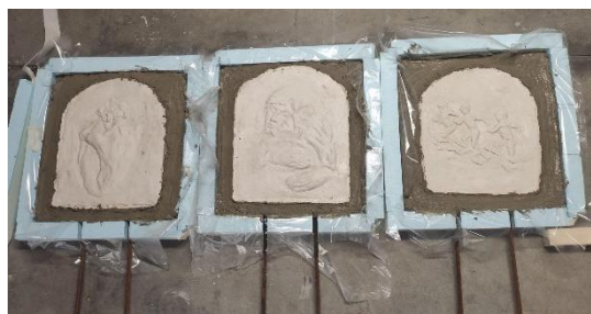
Fig. 14. Formigó forjat amb plaques d'escaiola a sobre
