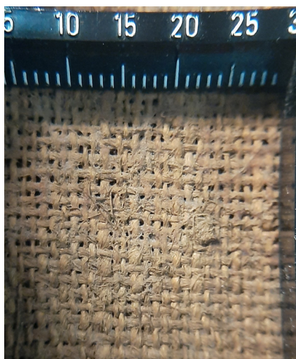
Figura 27. Fotografía de la densidad del tejido del entelado por cm 2 con cuentahilos.
