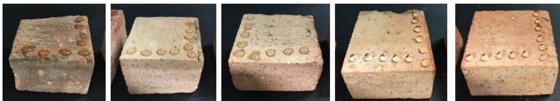
Figura 5. Aplicación sobre las probetas cerámicas, hidrofugadas con Silo® 111.
