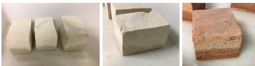
Figura 2(a-c). Frente de empapamiento. a-b) De la calcarenita, irregular. b) Del ladrillo, regular.
