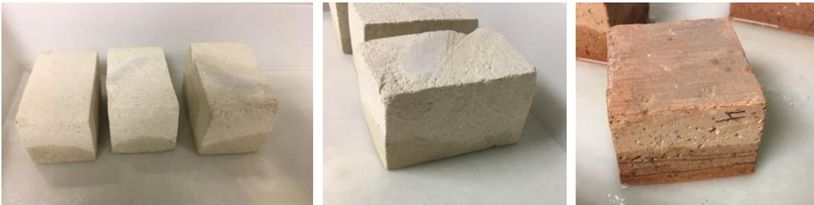
Figura 2(a-c). Frente de empapamiento. a-b) De la calcarenita, irregular. b) Del ladrillo, regular.
