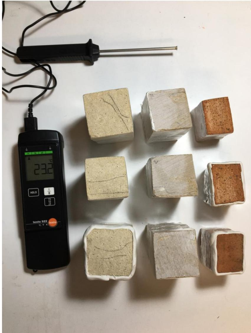
Figura 3. Comprobación de las condiciones de humedad y temperatura durante el ensayo
