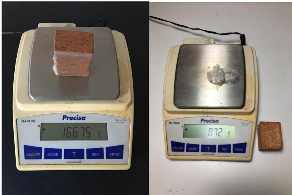
Figura 2 a-b. Pesado de la muestra y tara del material de sellado
