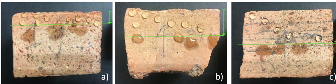
Figura 8. Frente de penetración de las probetas cerámicas, hidrofugadas con Silo® 111.
