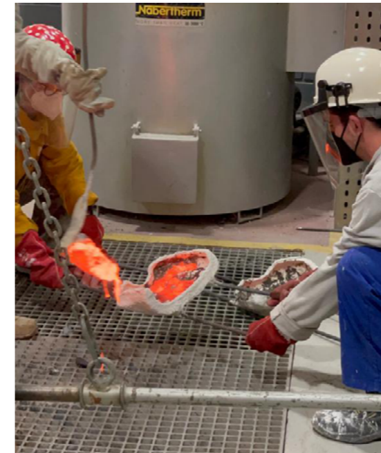
Fig.151. Diego Vidal. Proyectando latón sobre el molde.
