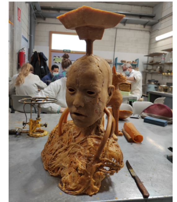
Fig.126. Diego Vidal. Pieza de cera con el árbol de colada completo.
