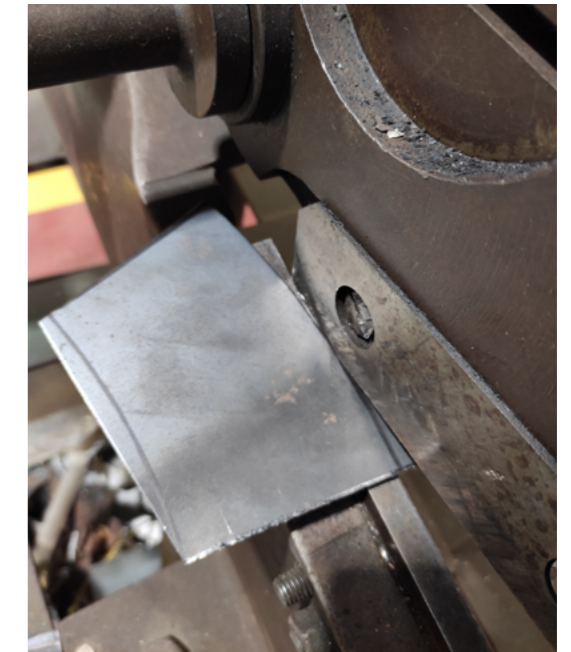
Fig.31. Diego Vidal. Corte de las piezas curvas con la cizalla de palanca.
