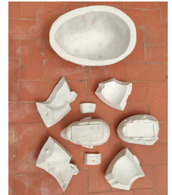
Fig.67. Diego Vidal. Molde completo desmontado.
