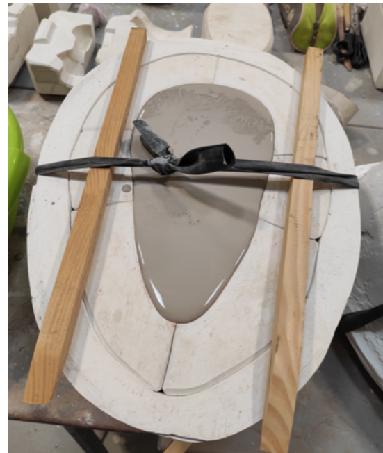
Fig.68. Diego Vidal. Molde lleno de barbotina.
