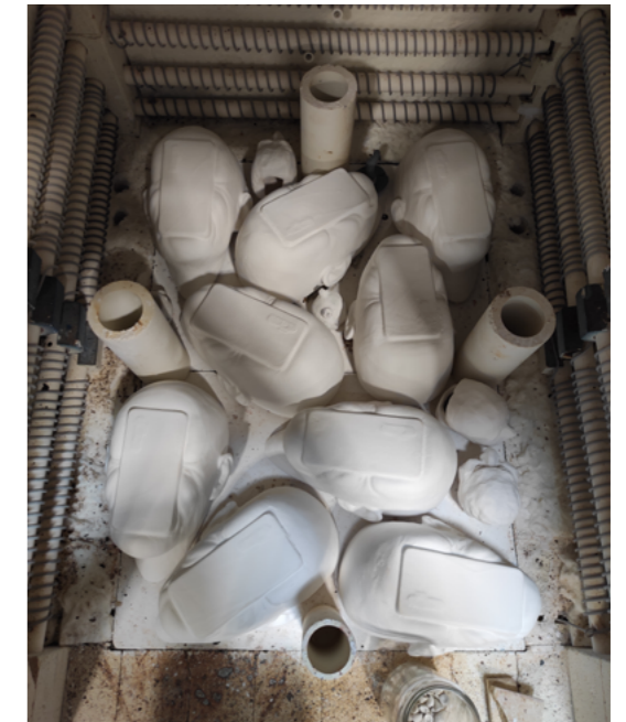
Fig.71. Diego Vidal. Piezas secas en el horno, para bizcochar.
