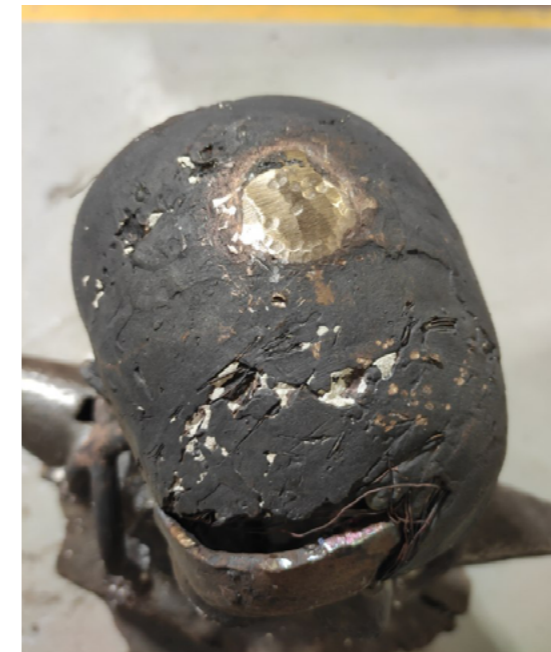
Fig.163. Diego Vidal. Martilleado de las zonas repasadas.
