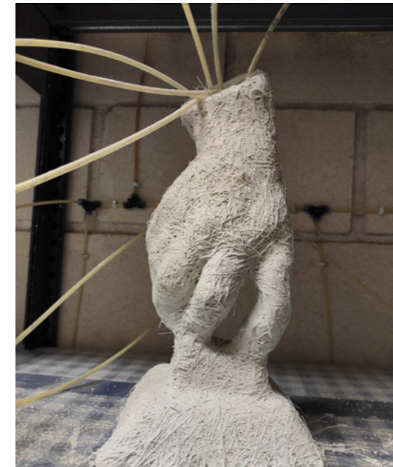
Fig.108. Diego Vidal. Molde de cáscara en el secadero.
