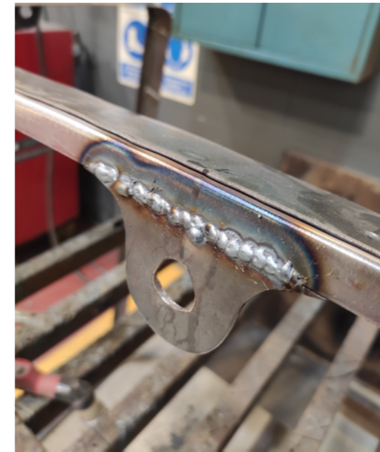
Fig.41. Diego Vidal. Soldado del soporte de las cámaras.
