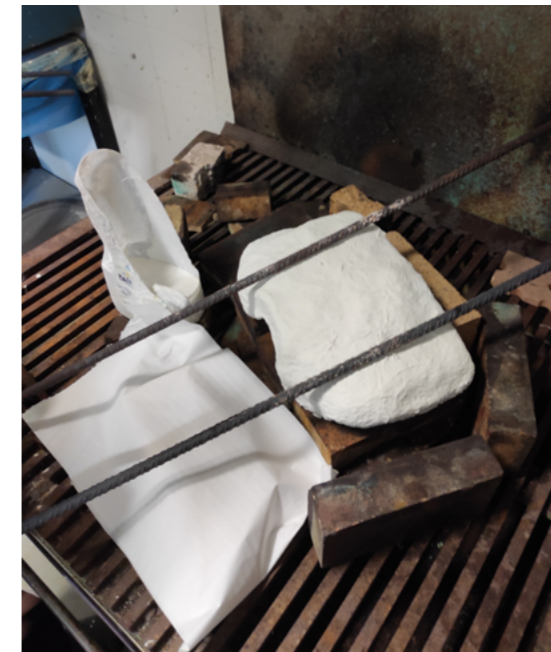
Fig.147. Diego Vidal. Soldado de los hierros al molde.
