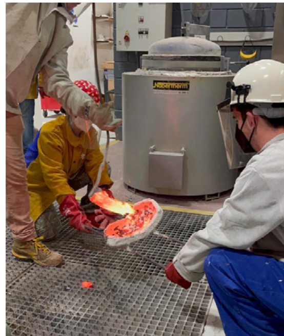
Fig.149. Diego Vidal. Proyectando bronce sobre el molde.
