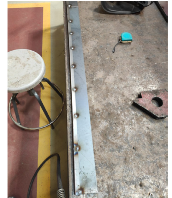
Fig.42. Diego Vidal. Punteado de los perfiles a las piezas laterales.
