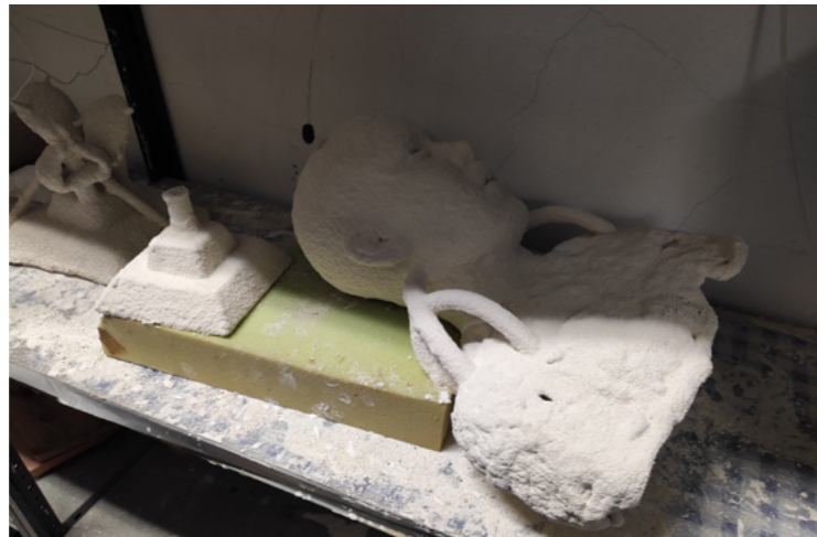
Fig.127. Diego Vidal. Molde roto tras tres capas de cáscara.
