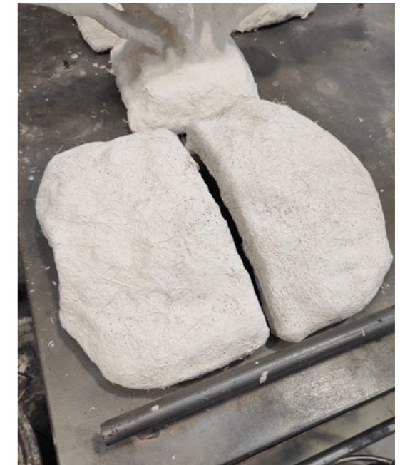
Fig.146. Diego Vidal. Moldes de cáscara cerámica de las dos piezas.
