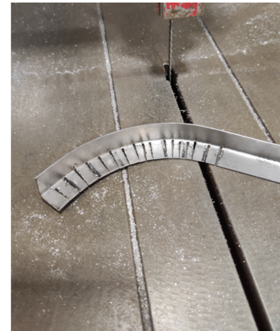
Fig.37. Diego Vidal. Curvado de las curvas del perfil "L".
