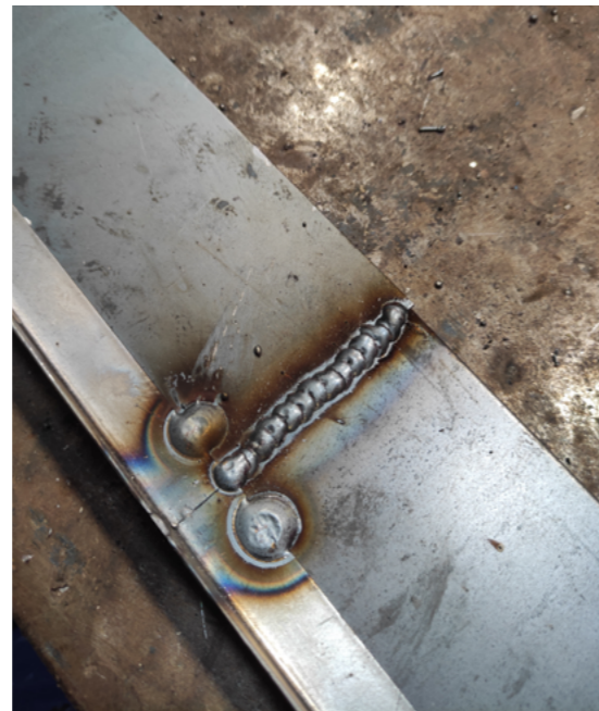
Fig.40. Diego Vidal. Soldado de la parte superior a los laterales.
