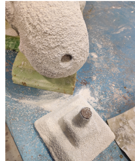
Fig.128. Diego Vidal. Limpieza de la unión antes de cocer el molde.
