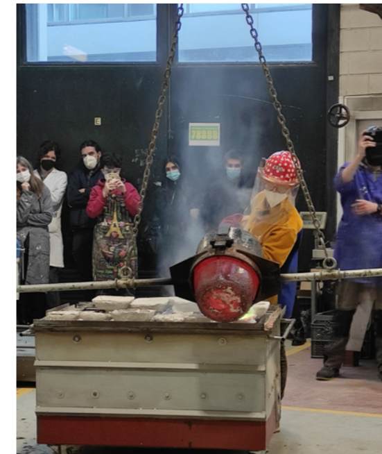
Fig.110. Diego Vidal. Colada del bronce en el molde.
