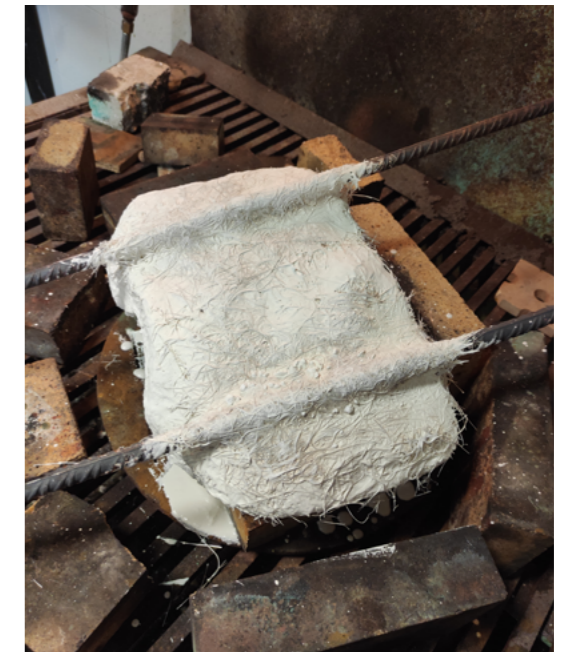
Fig.148. Diego Vidal. Soldado de los hierros al molde.
