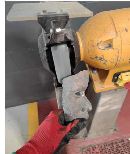
Fig.161. Diego Vidal. Repasado con la muela del esmeril.
