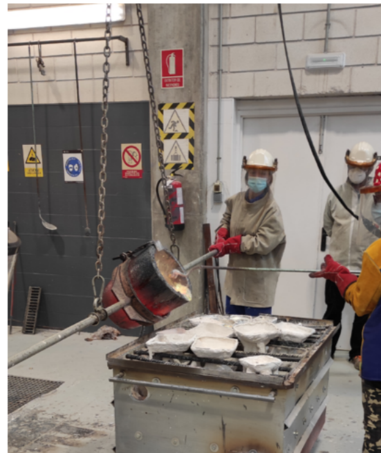
Fig.132. Diego Vidal. Colando el bronce en el molde de cáscara.
