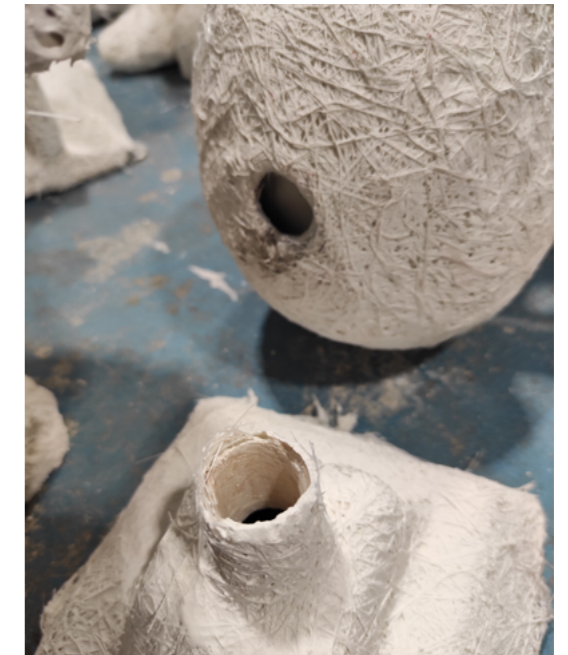
Fig.129. Diego Vidal. Molde desecado y cocido.
