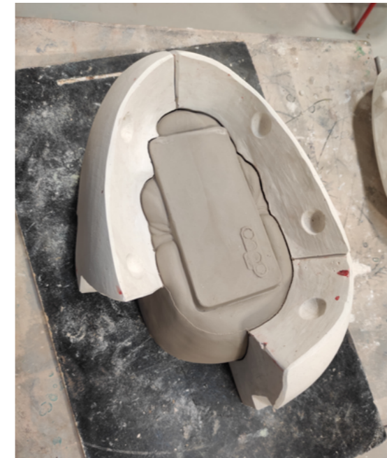
Fig.70. Diego Vidal. Desmoldeo de la pieza de loza.
