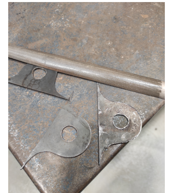
Fig.33. Diego Vidal. Corte de los soportes de las cámaras.
