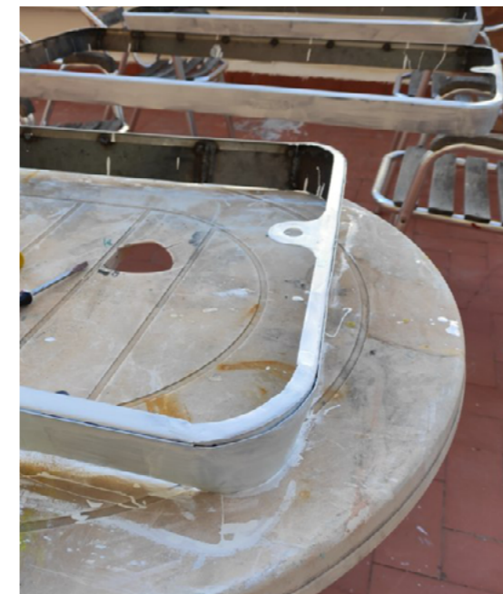
Fig.48. Diego Vidal. Aplicación de la imprimación
