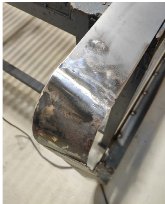
Fig.45. Diego Vidal. Repasado de soldaduras.
