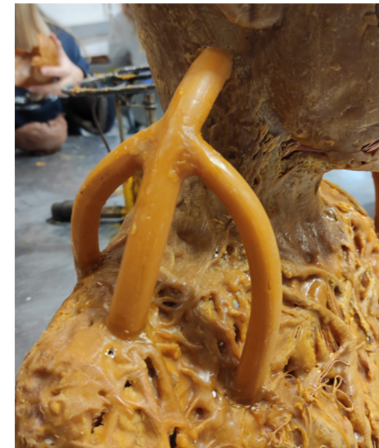
Fig.125. Diego Vidal. Detalle de los bebederos secundarios.
