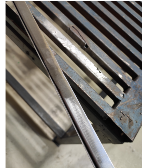
Fig.46. Diego Vidal. Repasado de soldaduras.
