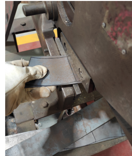
Fig.30. Diego Vidal. Corte de las piezas curvas con la cizalla de palanca.
