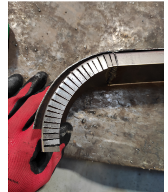
Fig.38. Diego Vidal. Curvado de las curvas del perfil "L".
