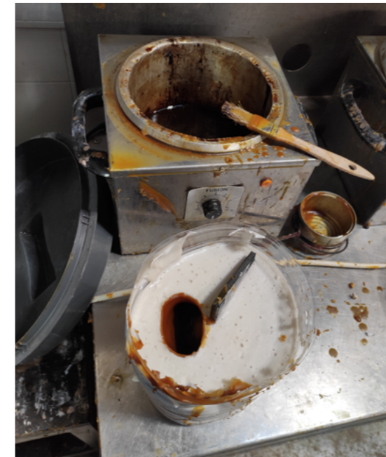
Fig.98. Diego Vidal. Molde llenado con una capa de cera adecuada para la pieza.
