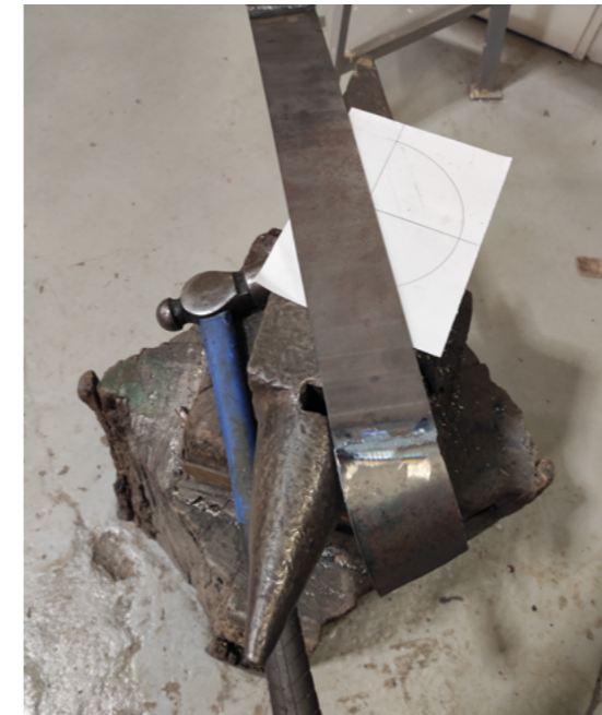
Fig.35. Diego Vidal. Curvado de las esquinas en el yunque.
