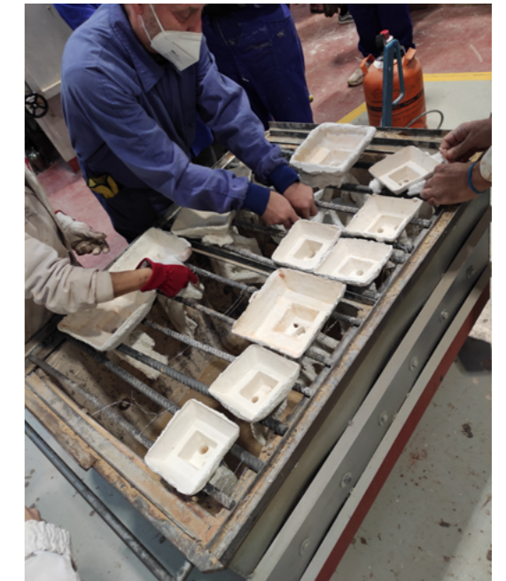
Fig.109. Diego Vidal. Colocación de los moldes en la cama de colada.
