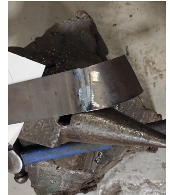
Fig.36. Diego Vidal. Curvado de las esquinas en el yunque.
