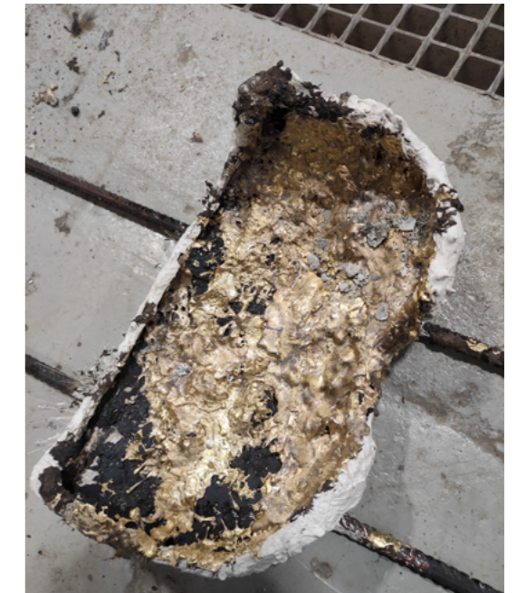
Fig.152. Diego Vidal. Resultado tras la proyección del latón.
