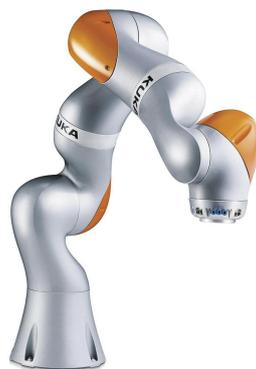
Figura 1.3: Robot colaborativo LBR iiwa de la marca KUKA <sup>4</sup>
