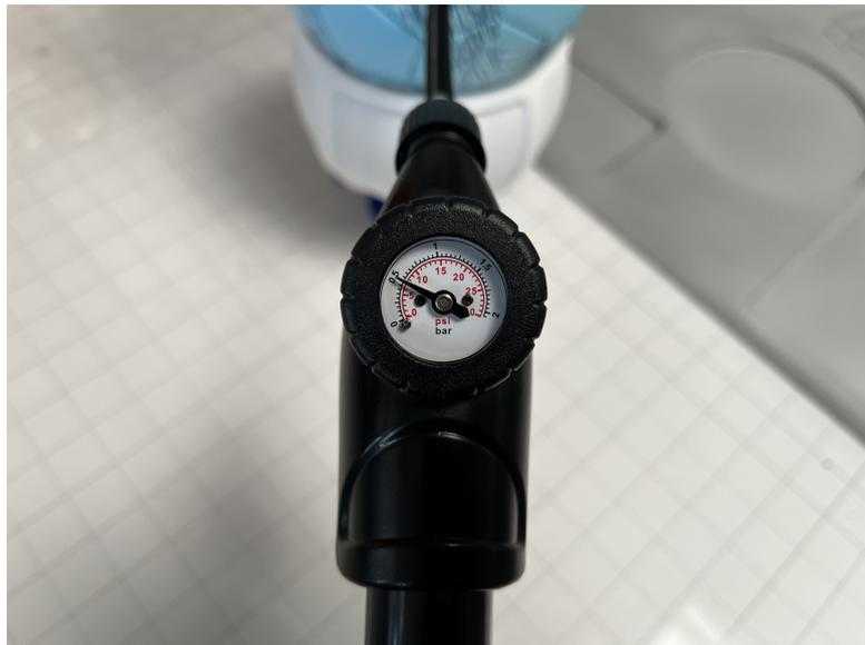
Figura 6.8: Manómetro empleado en la medida de presión en el interior de la pelota.
