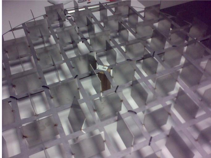
Fig.18. Buje colocado en el difusor para poder unir el pie de micrófono
