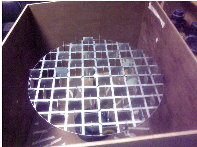
Fig.19. Modelo a escala unido a la estructura, en la cámara reverberante a escala
