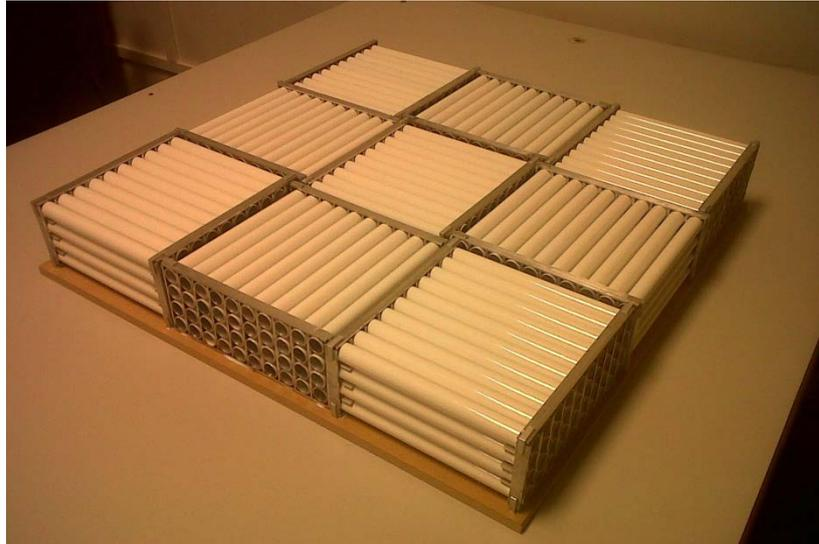
Fig. 32. Difusor a escala terminado (vista isométrica)
