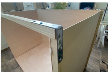
Imagen 14: Funcionamiento de las escuadras metálicas con los listones.
