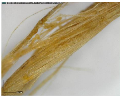
Imatge 21. Detall de la torsió de la fibra, amb microscopi digital Dino-lite®, model Premier Digital Microscope (210x augments).
