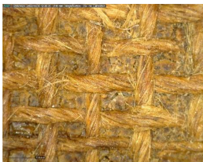
Imatge 20. Detall del suport original amb microscopi digital Dino-lite®, model Premier Digital Microscope (55x augments).
