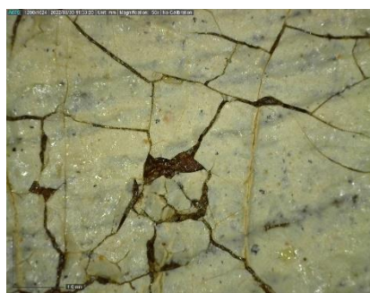
Imatge 27. Detall de faltant de pel·lícula pictòrica en que s'aprecia la capa de preparació. Microscopi Dino-lite®, model Premier Digital Microscope (55x augments).
