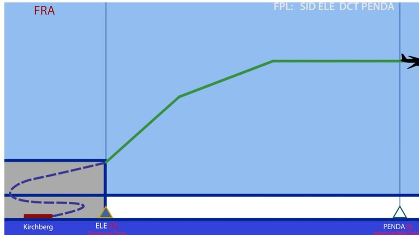
**Figura 2.34: Entrada un volumen FRA total empleando un procedimiento SID (EUROCONTROL)**
