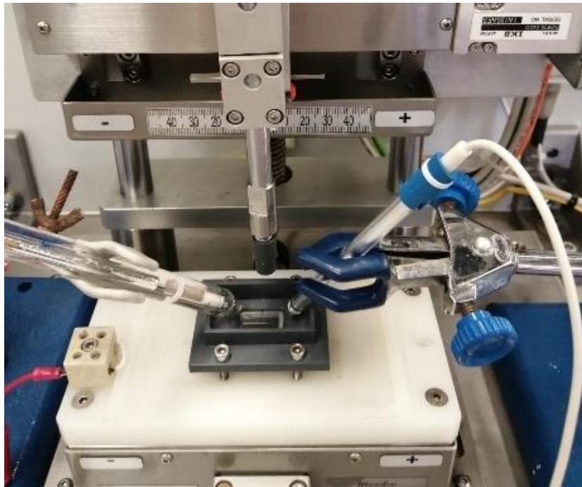
Figura 50 Montaje de los ensayos en húmedo.
