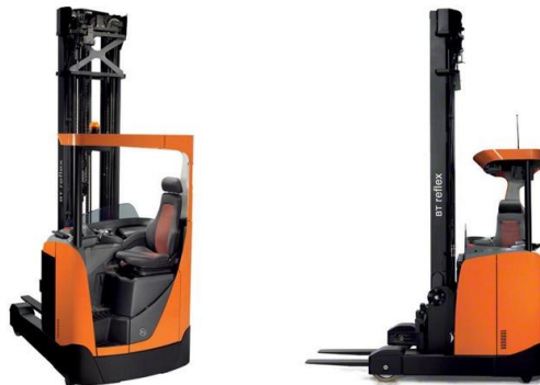
Ilustración 9. Detalle de carretillas retráctiles. Fuente: www.mecalux.es
