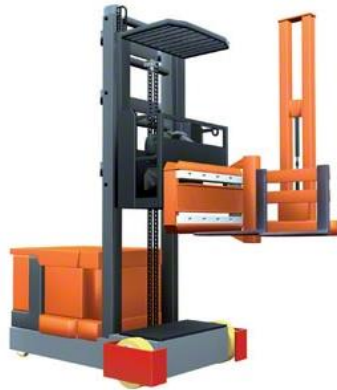
Ilustración 10. Detalle de carretilla torre trilateral. Fuente: www.mecalux.es
