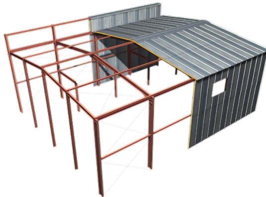
Ilustración 27. Cerramiento de la estructura. Fuente: Generador de Precios.
