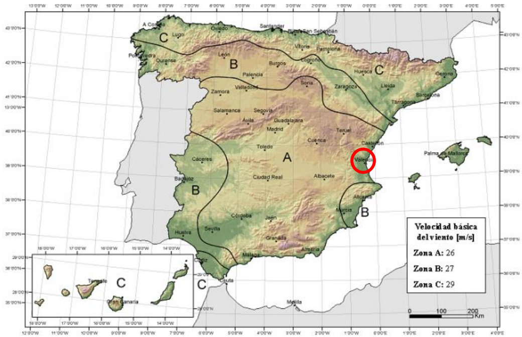
Ilustración 34. Valor básico de la velocidad del viento, v_b . Fuente: CTE DB SE-AE.
