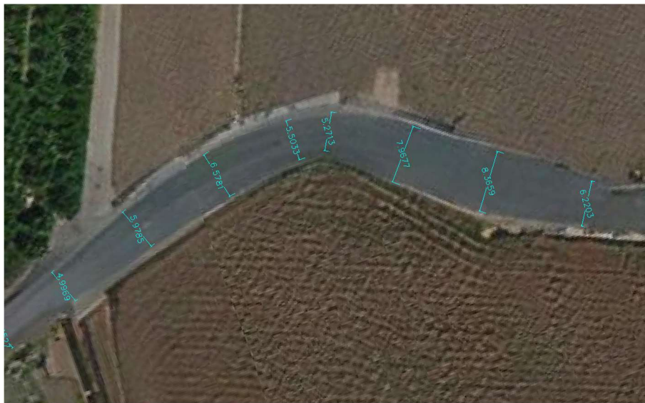
Imagen 42. Dimensiones de la sección transversal
