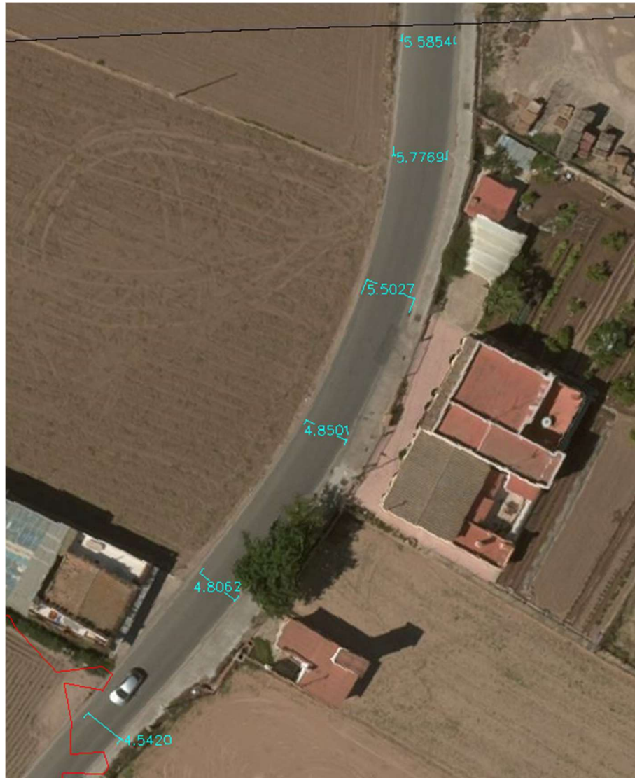
Imagen 36. Dimensiones de la sección transversal
