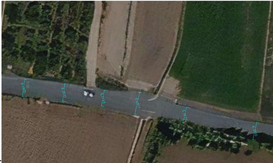
Imagen 43. Dimensiones de la sección transversal
