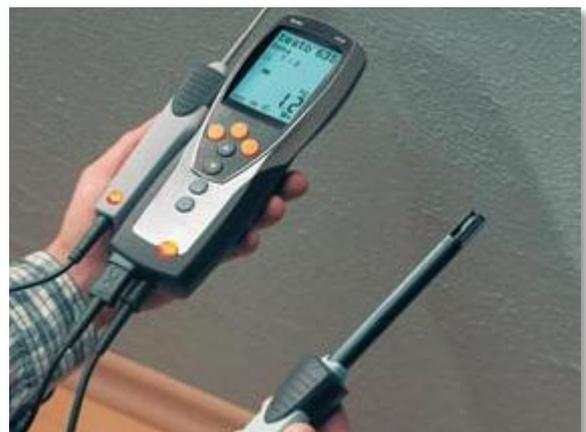
**Fotografía 9: Sonda de temperatura y humedad.**
