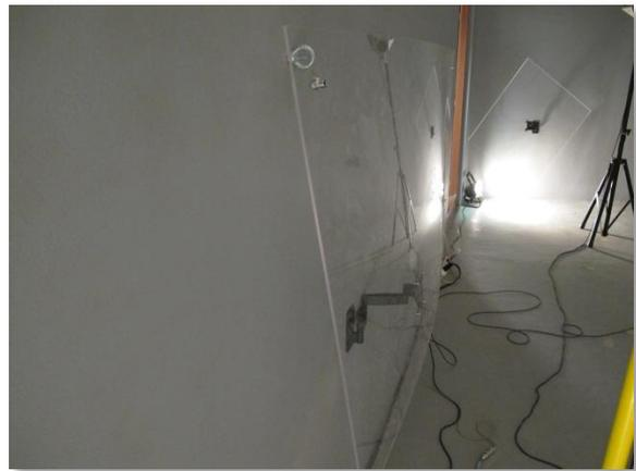
**Fotografía 16: Difusor de pared con soportes tipo cáncamo y aluminio.**
