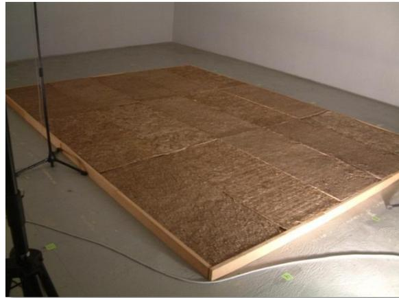
**Fotografía 11:** Colocación de la muestra patrón en la cámara reverberante.
