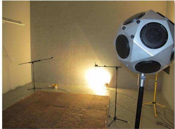
**Fotografía 7: Fuente de ruido omnidireccional.**
