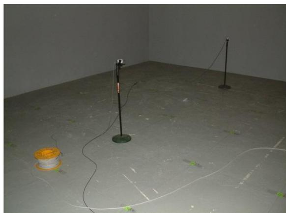
**Fotografía 22: Medida de SPL en cámara vacía sin difusores a 1 metro de altura. Puntos 3 y 18.**
