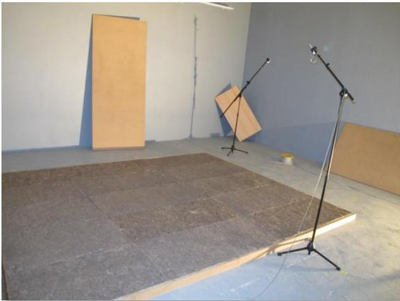
Fotografía 23: Colocación de los difusores de madera provisionales en paredes y suelo.
