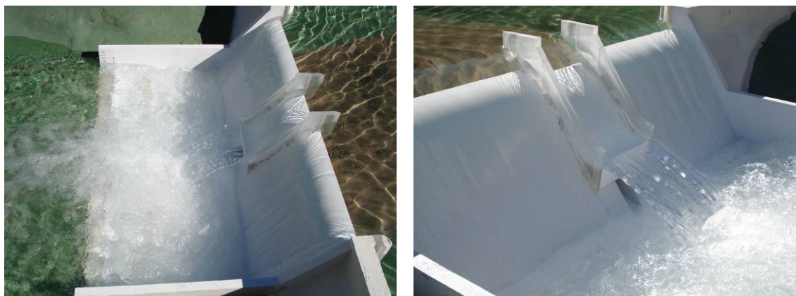
Figura 18. Funcionamiento de los órganos de disipación de energía para el caudal de Avenida de Proyecto
