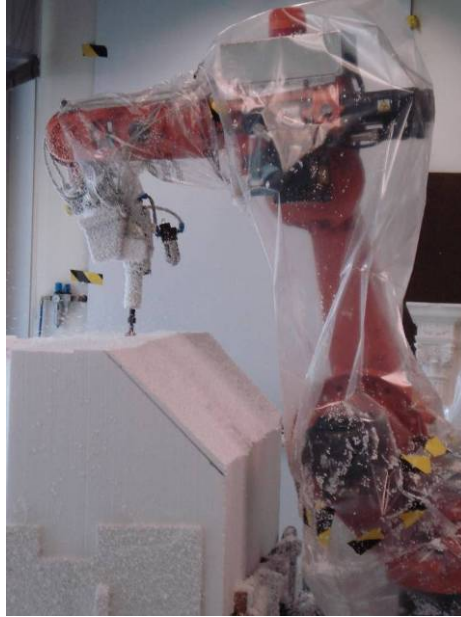
Figura 5. Mecanizado de bloques
