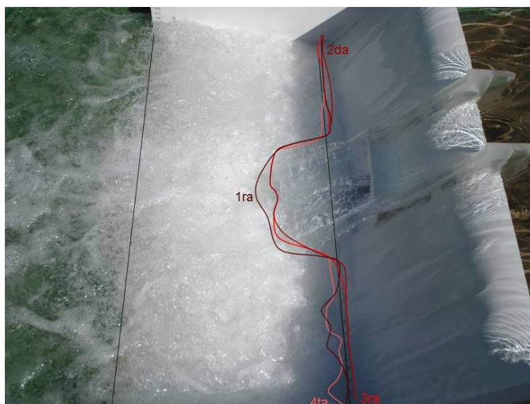
Figura 19. Avenida Extrema. Envolvente de posición de los frentes de resalto
