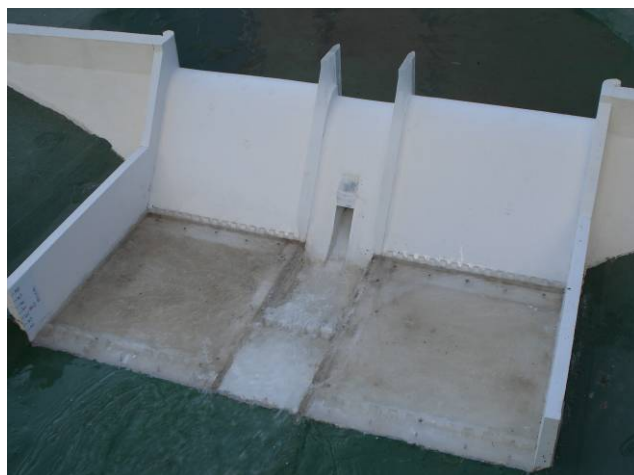
Figura 13. Vista desde a. abajo. Modelo sin cajeros intermedios en zona de cuencos
