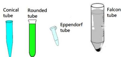
**Figure 1.** Tubes for centrifugal separations at lab scale (Técnicas de laboratorio en bioquímica. Centrifugación. <http://biomodel.uah.es/>).
