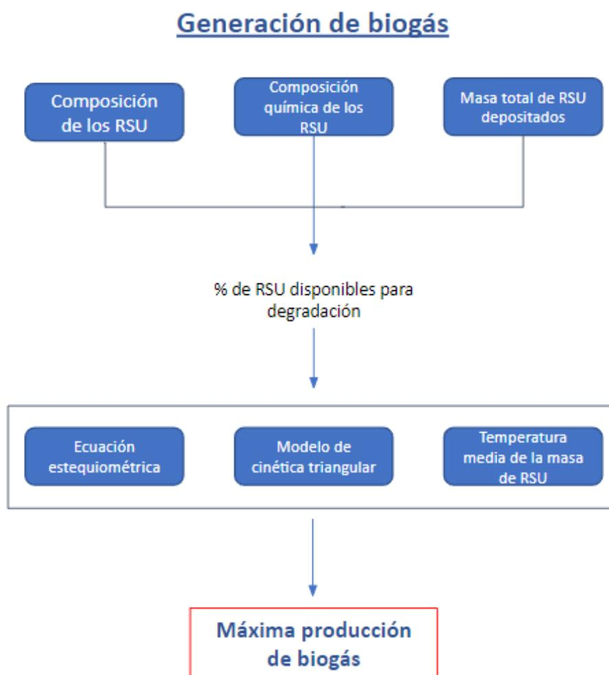
Figura 4.3.- Diagrama de flujo del módulo de producción de biogás propuesto del modelo BIOLEACH [79]
