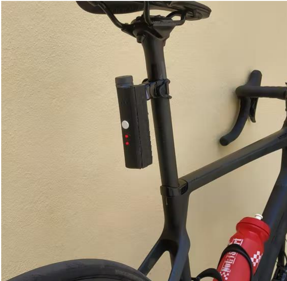
Figura 31. Dispositivo de detección y localización de accidentes.
