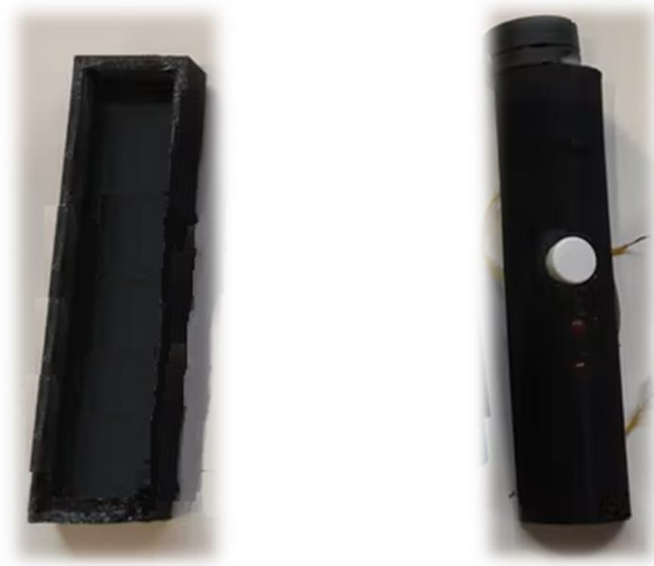
Figura 21. Carcasa trasera y delantera con 2 Led, botón y buzzer y sensor de movimiento.
