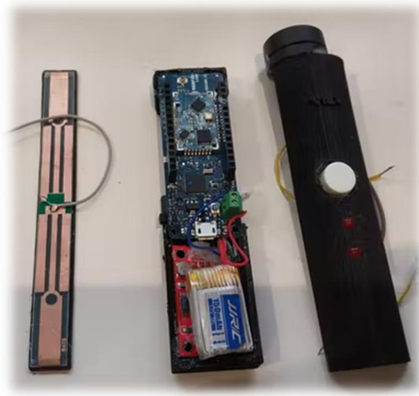
Figura 23. Arduino MKR, Módulo GPS y batería ya montados sobre la carcasa trasera.
