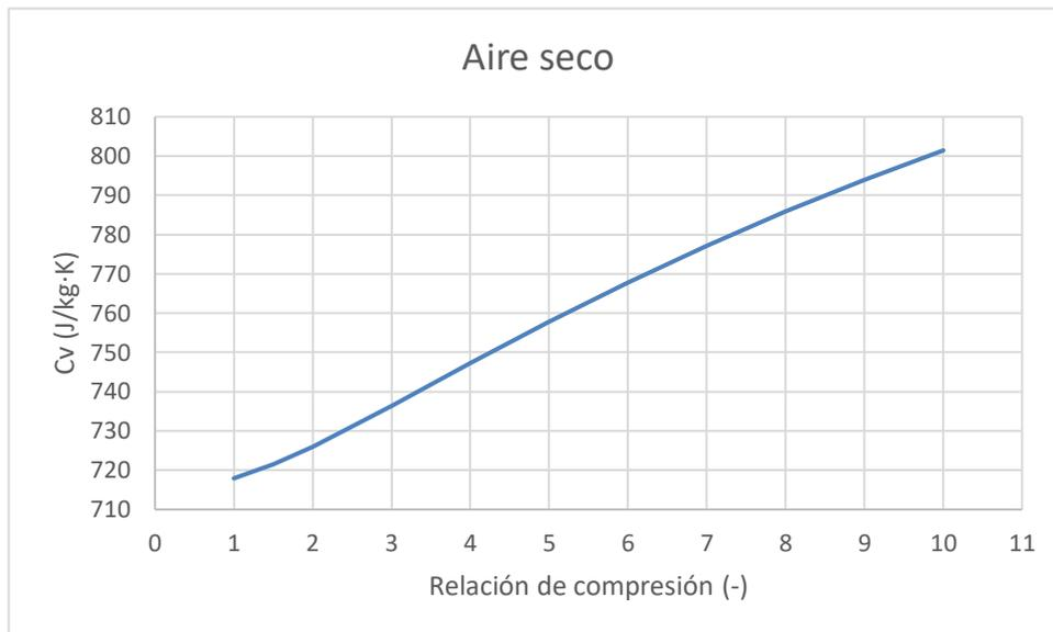
Figura 16. Calor específico a volumen constante del aire en función de la relación de compresión
