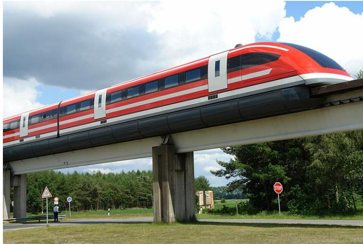
Figura 1.4: *Transrapid* alemán. Tren de levitación magnética (maglev) [9]
