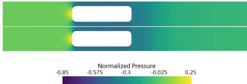
Figura 4.34: Contorno de Presión Normalizada. Estacionario (arriba) y transitorio (abajo). Segmento de aceleración ( $V = 45 \text{ m/s}$ )
