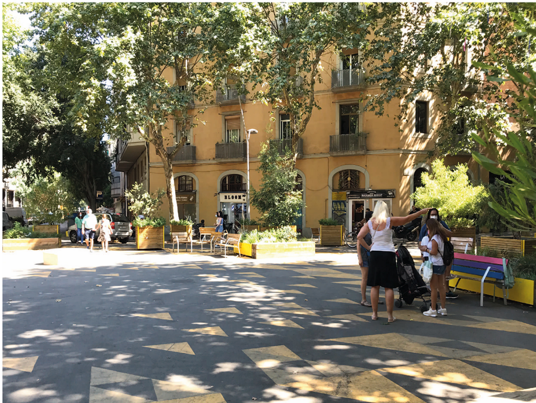
Figura 42. Proyecto Super Illa. Fase táctica. Es la adaptación de cruces con pintura y mobiliario temporal para retirar zonas de aparcamientos y de circulación vehicular, y generar una isla peatonal. Existen opiniones confrontadas sobre estas intervenciones; por un lado lo positivo es el aumento de espacios públicos de uso peatonal, y por otro se cuestiona la calidad de la intervención y la necesidad de mayor participación vecinal. Fuente: elaboración propia.
