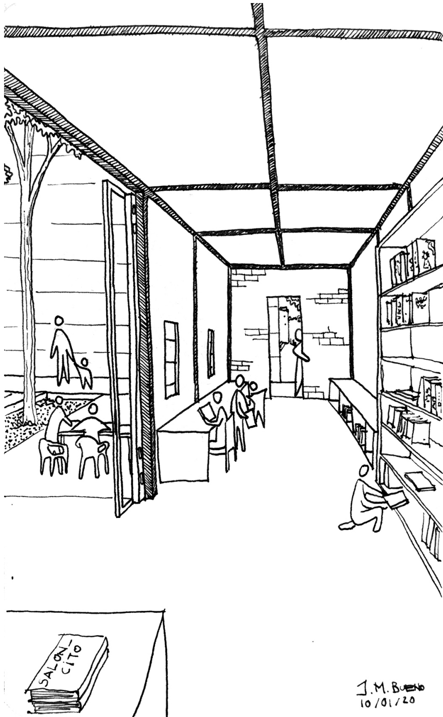
Figura 86. El saloncito. Este es un espacio que ya funcionaba antes de la intervención, y tenía una identidad definida en la unidad de vivienda, por lo que se concreta a partir de las actividades existentes. El módulo metálico central se adapta para dar cabida a el nuevo saloncito, el cual fue cerrado con muros de mampostería y acondicionado con grandes ventanales que se pueden abrir e integrar el espacio hacia el exterior. Su función ha sido lúdica y educativa, ya que es un espacio para hacer tareas escolares, leer, hacer talleres de manualidades, entre otros, aprovechadas principalmente por la población infantil y mayores. Fuente: elaboración propia.
