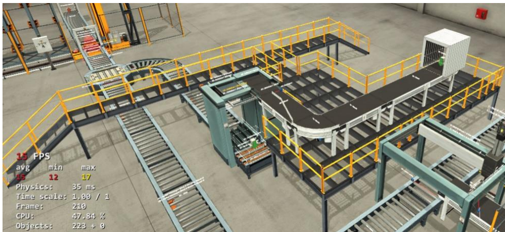
Figura 15. Línea de paletizado de cajas prefabricadas.
