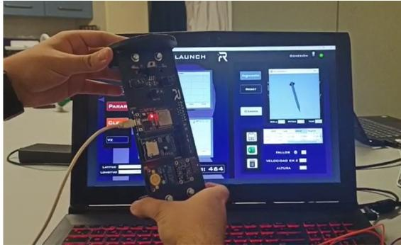
**Figura 6.11:** Visualizando la orientación de la cápsula con la animación 3D.
