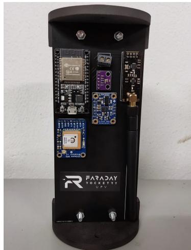
Figura 3.40: Cápsula de Aviónica RF - V3.
