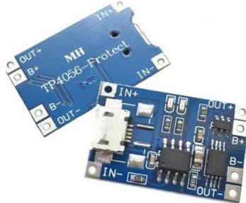
**Figura 3.4:** Cargador TP4056 para Baterías con protección micro USB.
