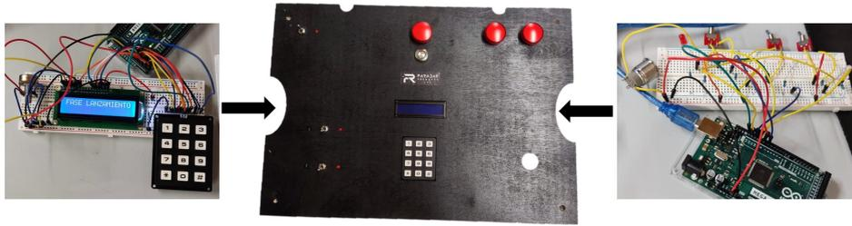
Figura 4.16: Proceso fabricación panel de control - Estación de Tierra.
