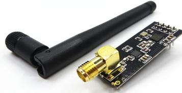
**Tabla 3.11:** Características del módulo de radiofrecuencia NRF24L01.
