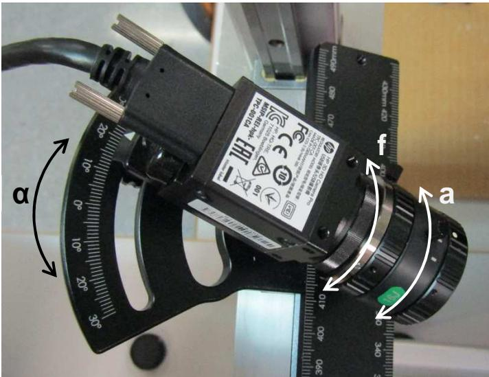
Figura 6. Parámetros que ajustar en las dos cámaras.
