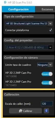
Figura 11. Casilla del programa donde indicar la escala de calibración a emplear
