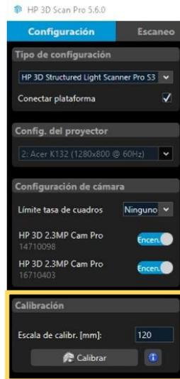
Figura 47. Casilla del programa donde indicar la escala de calibración a emplear.
