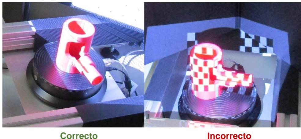
Figura 39. Colocación de la pieza a escanear sobre la base giratoria.
