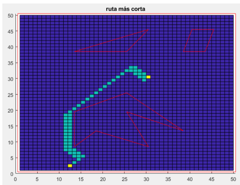
Figura 57. Ejemplo de representación gráfica del proceso 7 del script celdas1.m . Calcula la ruta a partir del campo potencial de la Figura 54.
