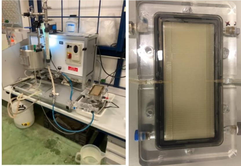
Figura 10. Planta piloto de UF (izq) – Módulo membrana (rayflow) (der)
