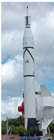
**Figura 2.1:** Cohete Juno I, vehículo lanzador del Explorer I.
