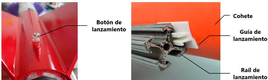
Figura 2.8: Botones y guía de lanzamiento colocados en un cohete.
