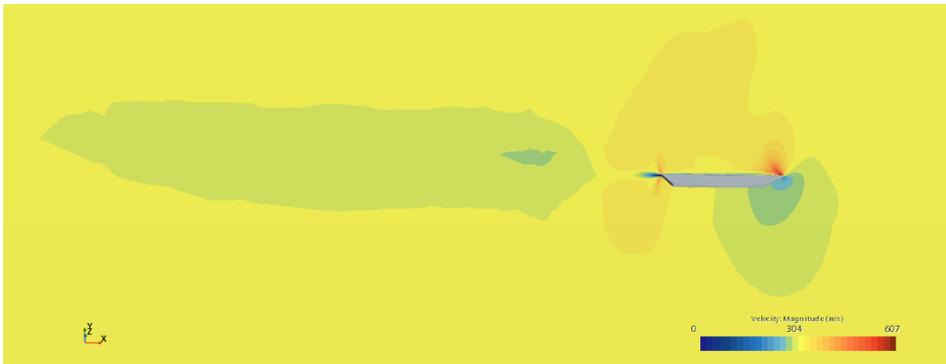
**Figura 5.23:** Escena de velocidad alrededor de la sección de la aleta con  $\alpha = 10^\circ$ .
