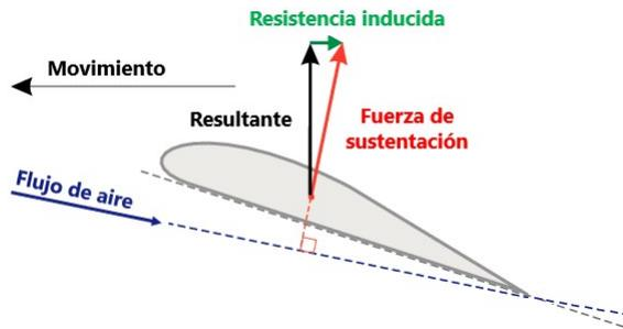
**Figura 2.9:** Generación de resistencia inducida en un perfil
