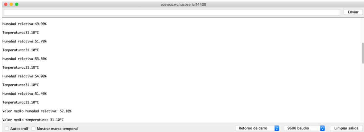
Figura 14: Medición de temperatura y humedad, monitor serie Arduino IDE
