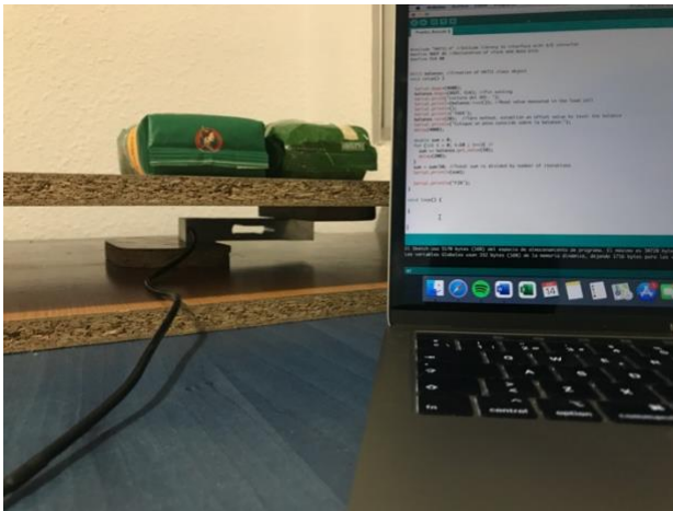
Figura 21: Sistema de pesaje con celda de carga WL1243 y Arduino IDE
