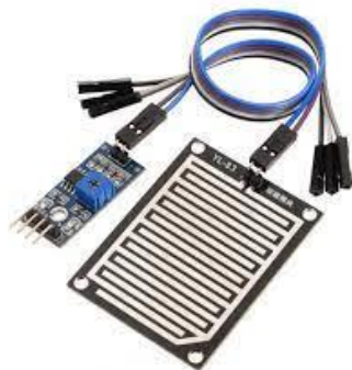
Figura 4: Sensor de lluvia YL-83 y circuito integrado comparador LM393
