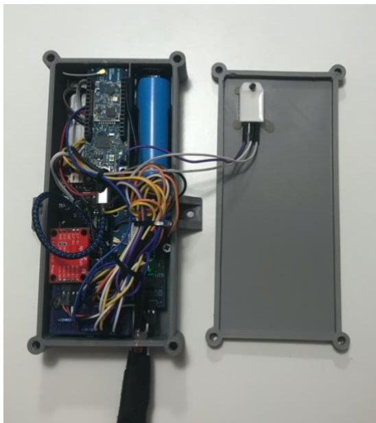
Figura 42: Carcasa principal y tapa junto a los componentes electrónicos ensamblados
