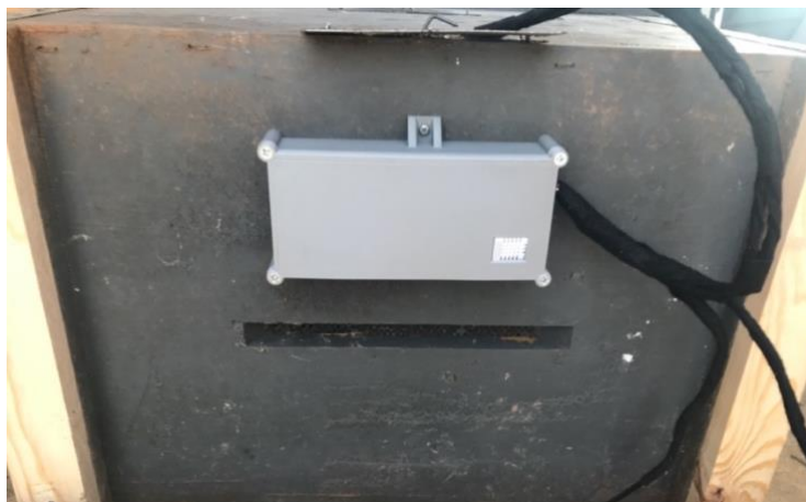
Figura 43: Carcasa principal completa, colocación en colmena Layens
