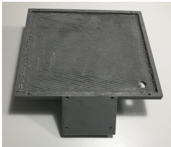
Figura 40: Soporte celda solar y sensor de lluvia, impresión 3D
