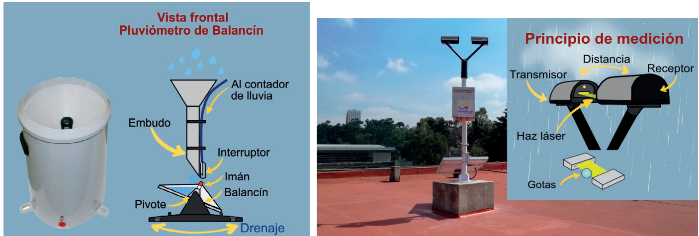
Figura 3 | Las redes de medición comparadas utilizan pluviómetros de balancín (a la izquierda) y disdrómetros ópticos láser (derecha) (Elaboración propia con base en las figuras de los manuales de los fabricantes (HyQuestSolutions, 2022) y (OTT, 2016).
