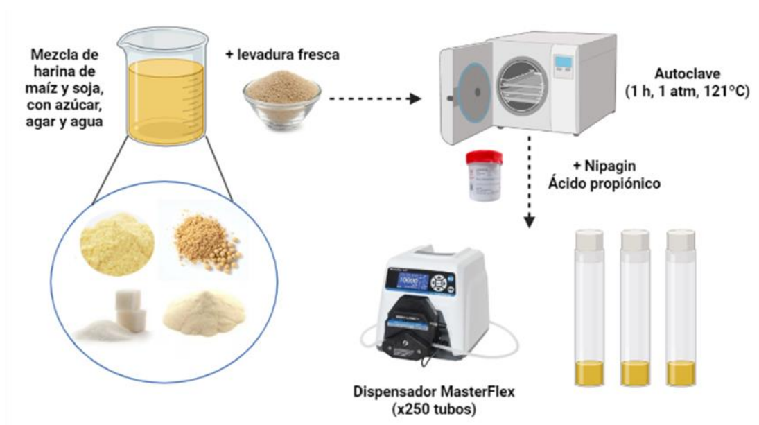
Figura 5. Representación esquemática del proceso de elaboración del medio de cultivo para D. melanogaster . Creada con Biorender.
